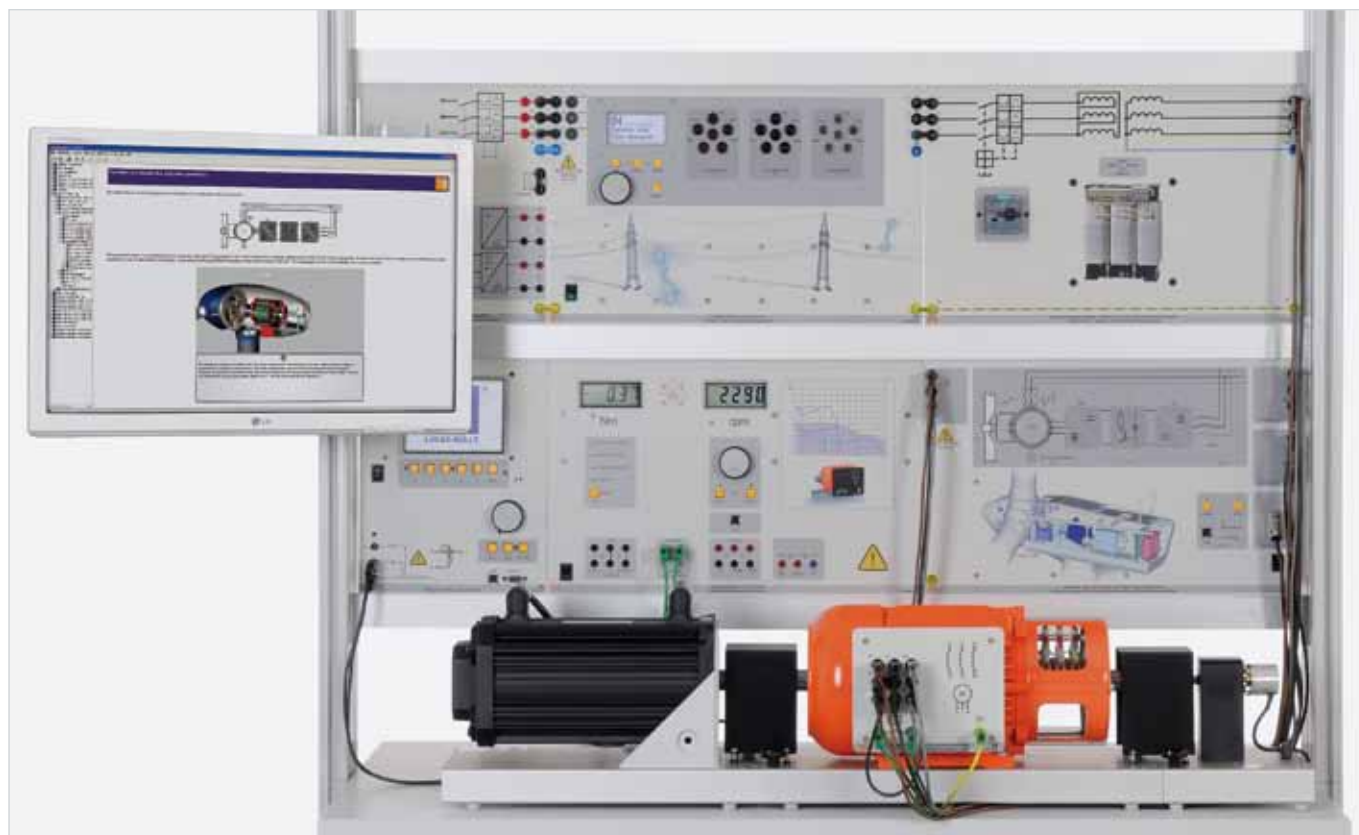
Exemple d'expérience « Éolienne EWG 1 »
