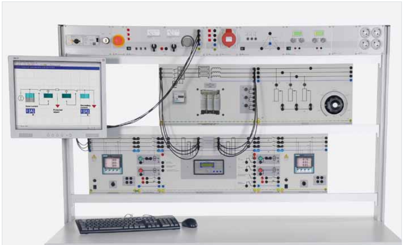
Exemple d'expérience « Protection différentielle du transformateur ETP 1 »
