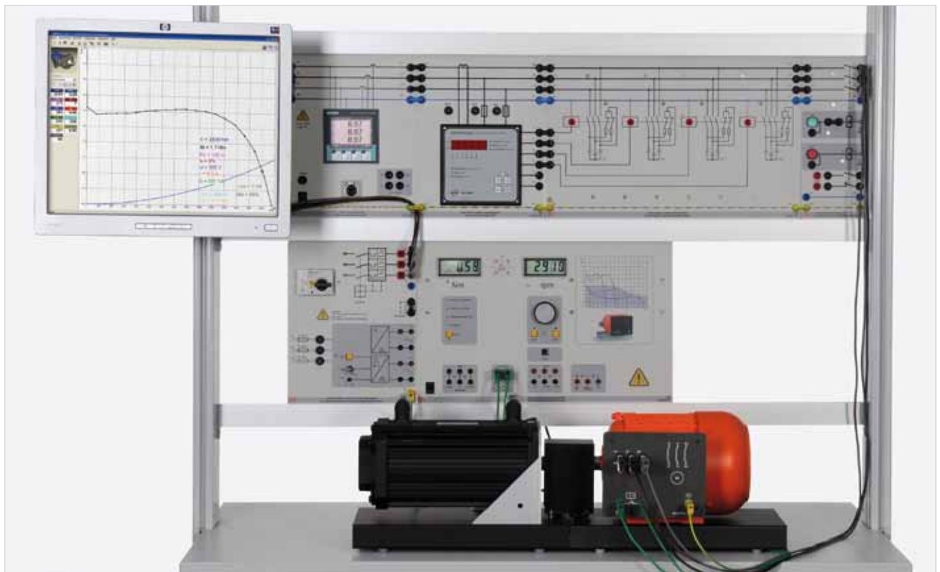
Exemple d'expérience « Compensation automatique de la puissance réactive EUC 3 »
