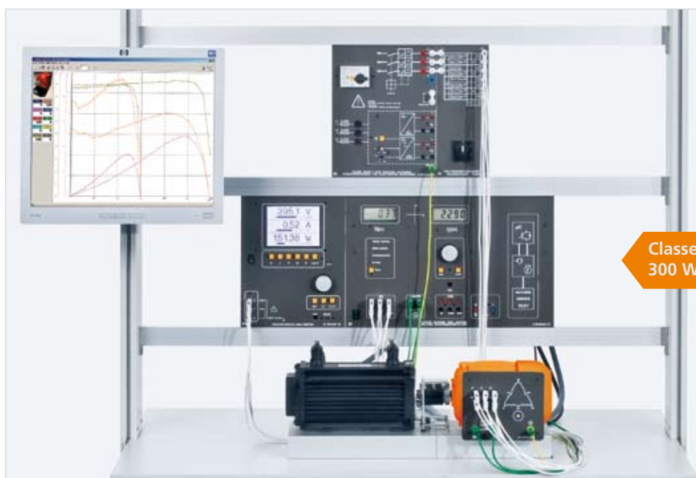
Exemple d'expérience « Moteur triphasé à nombre de pôles variable selon Dahlander EEM 4.2 »
