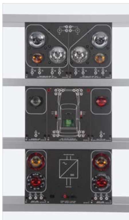
Experimento: "Iluminación de un vehículo controlada por el bus CAN" con la interfaz SO3216-2Z y componentes adicionales
