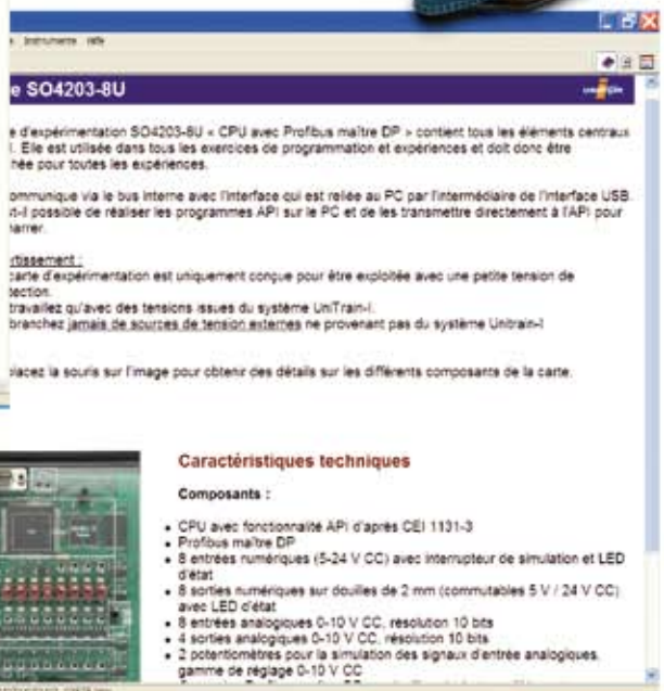
La carte d'essai contient tous les éléments essentiels d'un API
