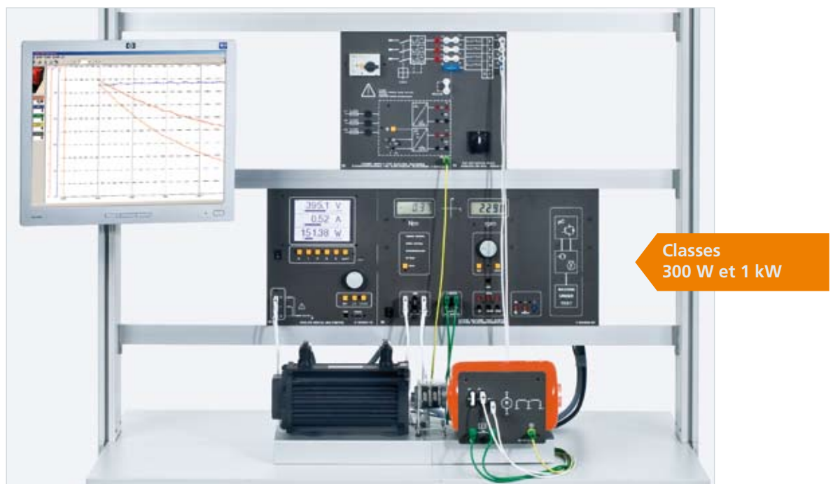
Exemple d'expérience « Machines à courant alternatif EEM 3.1 »
