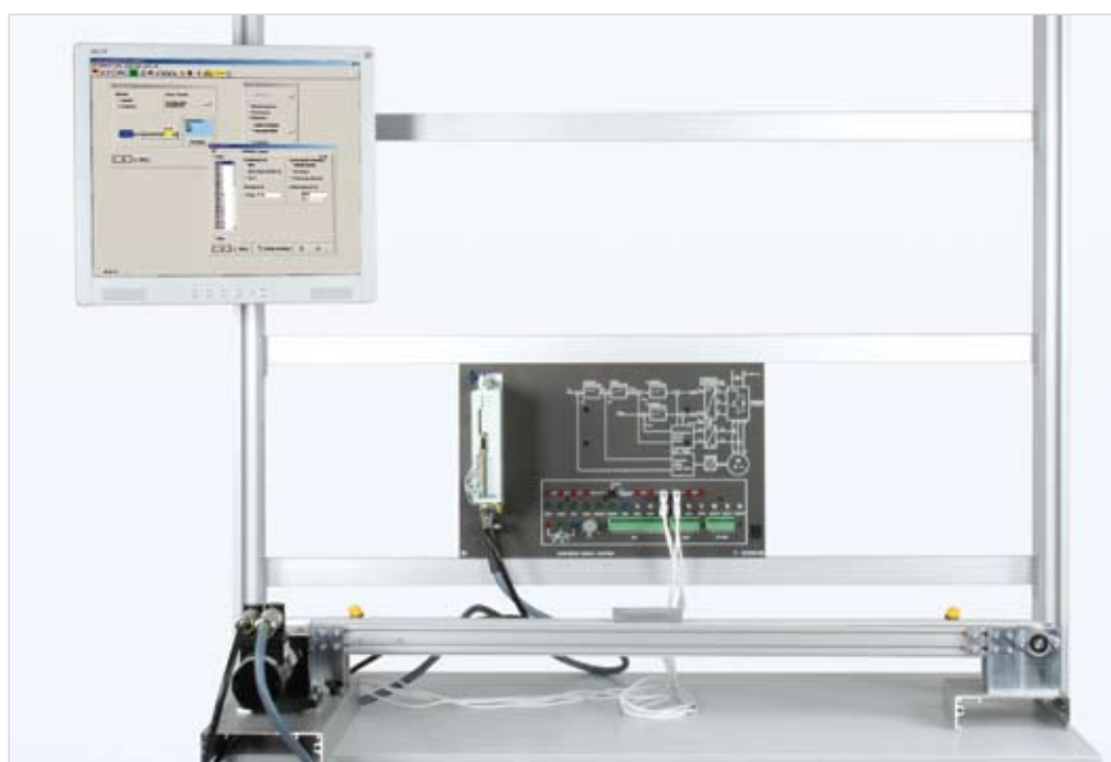
Exemple d'expérience « Positionnement avec entraînements asservis synchrones EDT 32 »
