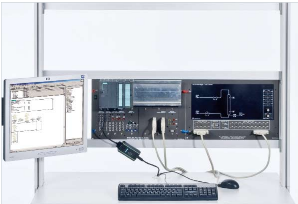
Mẫu thí nghiệm "Bộ mô phỏng hệ thống điều khiển vận năng PLC CLC 34"
