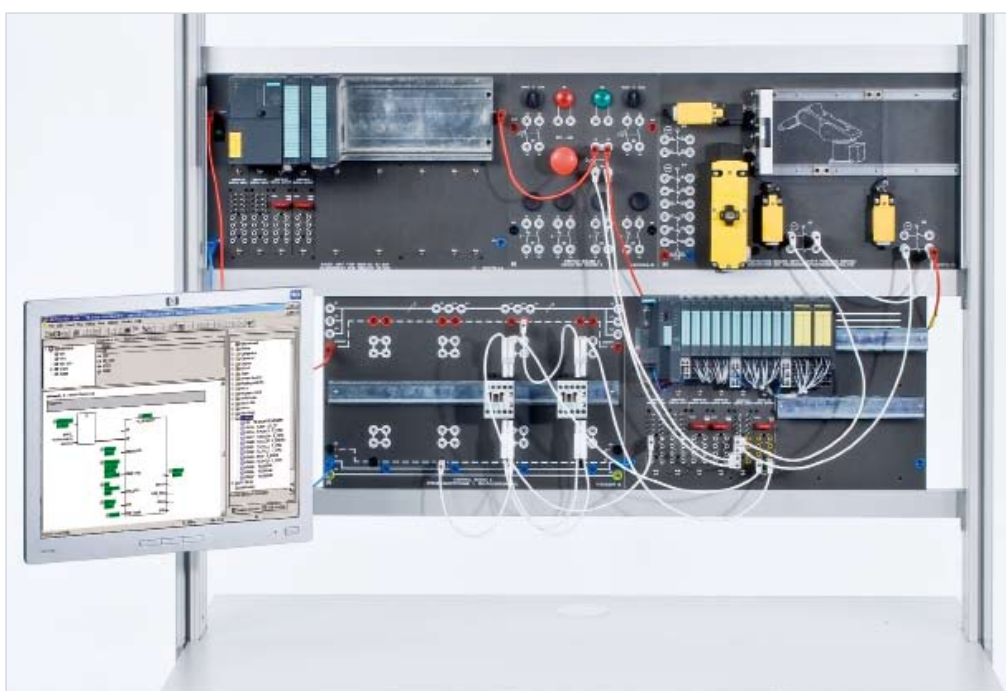
Mẫu thí nghiệm "PROFIsafe với PLC 'an toàn' CSY 3"
