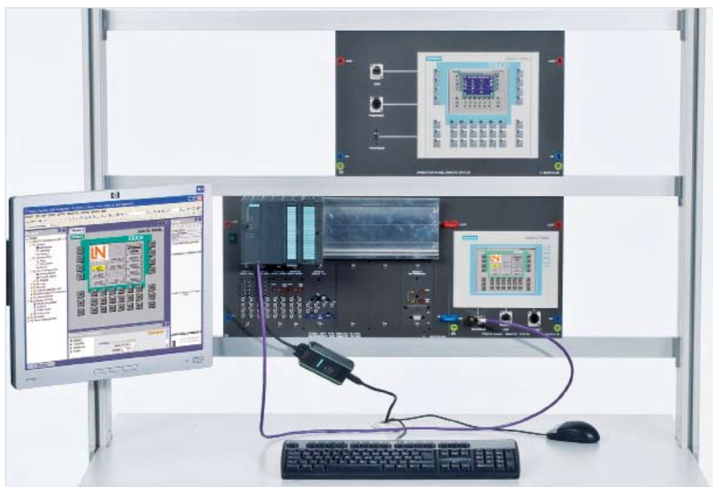
Mẫu thí nghiệm "Điều khiển và giám sát CCS 2"
