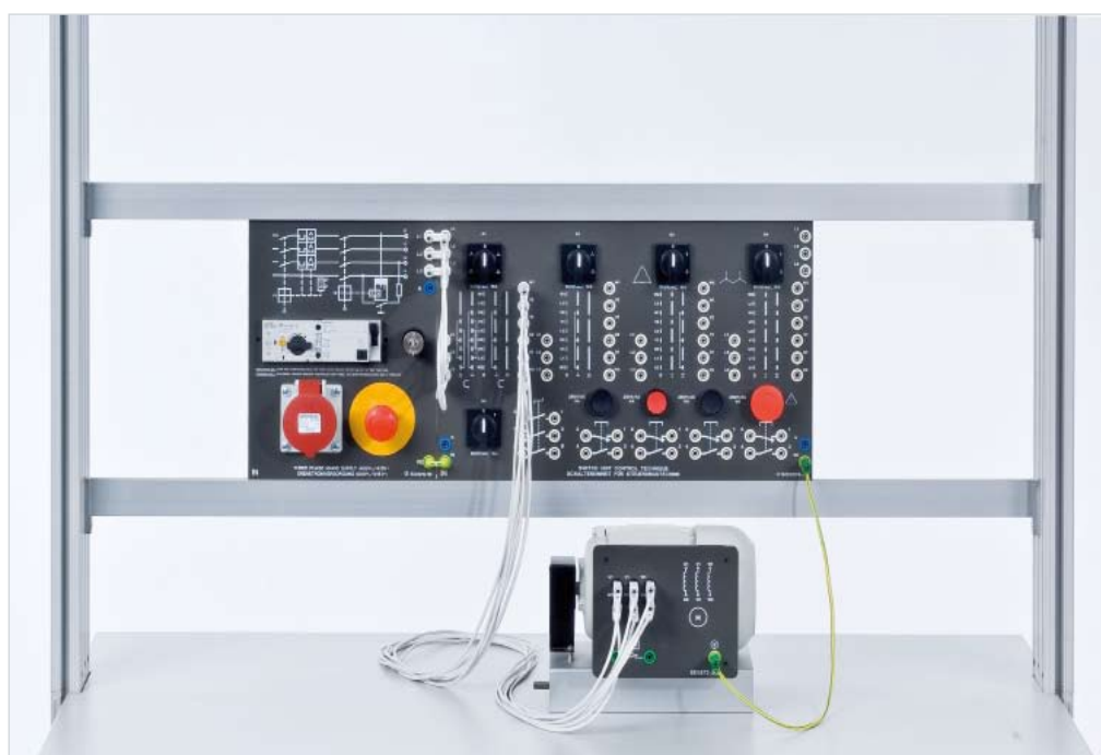
Mẫu thí nghiệm "Chuyển mạch bằng tay trong mạch ba pha EST 1"
