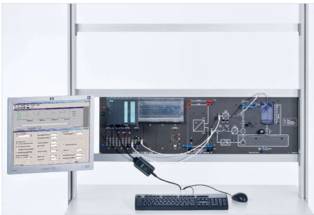
Mẫu thí nghiệm "Hệ thống điều khiển mức chất lỏng CLC 36"
