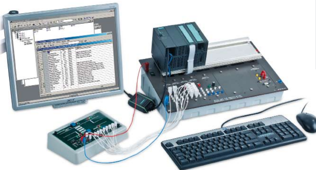
Mẫu thí nghiệmk "Bảng mạch in PLC – mô hình đèn giao thông CLC 33"
