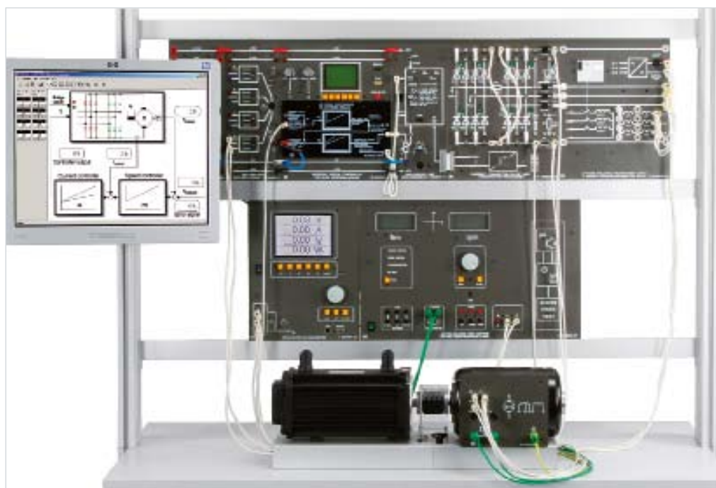
Mẫu thí nghiệm "Vòng điều khiển kín điều khiển tốc độ động cơ một chiều EPE 11"
