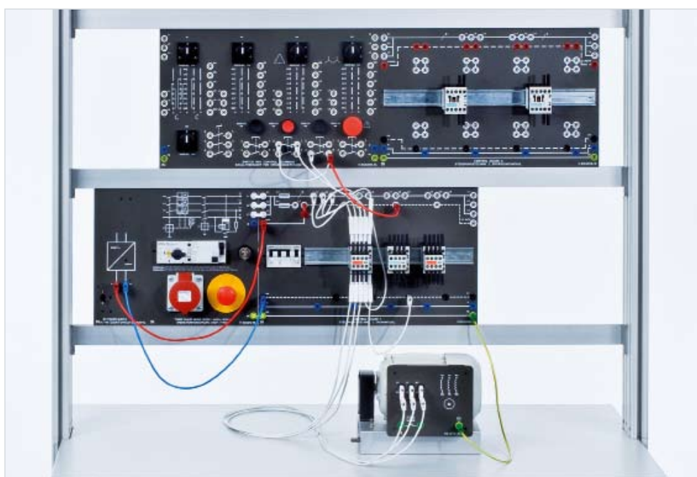
Mẫu thí nghiệm "Mạch công tắc tơ trong mạch ba pha EST 2"
