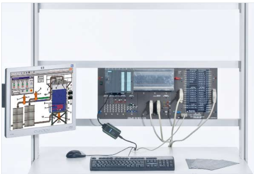
Mẫu thí nghiệm "Mô phỏng quá trình với ProTrain (xưởng nhiên liệu) CLC 35"
