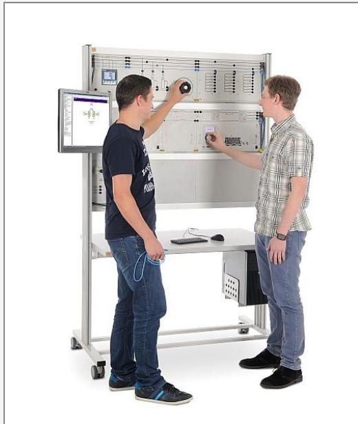
Herkömmliche Drehstrom-Hochspannungs-Übertragungsleitungen sind auf einer Langstrecke unwirtschaftlich, da unterwegs viel Energie verloren geht. Die Lösung sind Gleichstromleitungen. Darauf vorbereitet werden die Fachkräfte von morgen mit dem neuen Trainingssystem „Hochspannungs-Gleichstrom-Übertragung (HGÜ)“.
