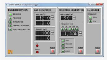
Der Ausbilder bzw. Dozent wählt einfach das gewünschte Teilmodul des Multi-Power-Supply an, gibt spezielle Wechsel- oder Gleichstromspannung sowie Signale ein und ordnet sie einzelnen Schülerarbeitsplätzen, Arbeitsgruppen oder der gesamten Klasse zu. Diese Einstellungen können nicht an den Arbeitsplätzen, sondern nur am Hauptgerät geändert werden. Der Sicherheitsaspekt im Klassenraum wird so deutlich erhöht.
