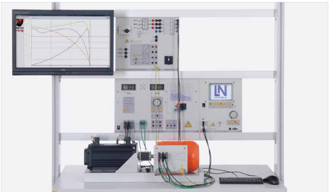
Trainingsystem „Energiesparmotor“ bestehend aus Höchsteffizienzmotor und Servo-Maschinenprüfstand.
