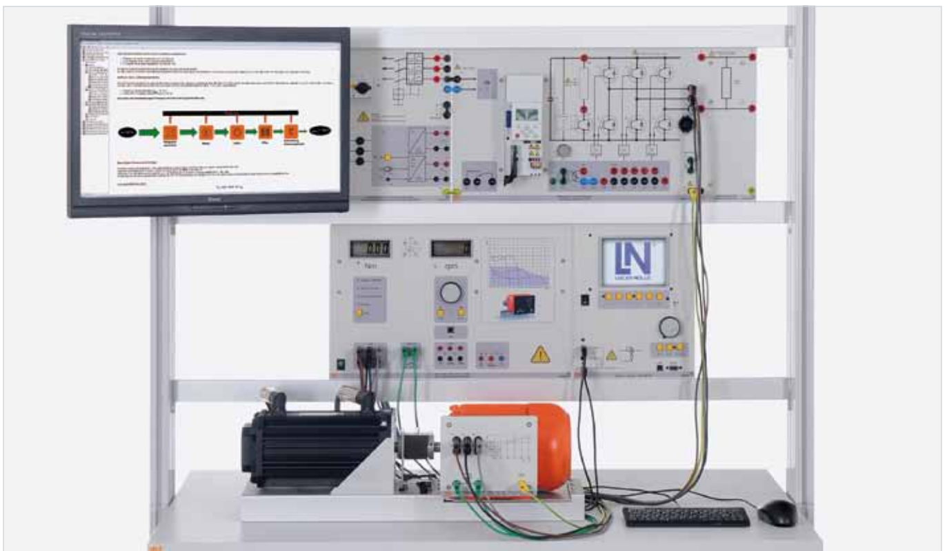
Trainingssystem „Energieeffiziente Antriebe mit Frequenzumrichtern“ bestehend aus Höchsteffizienzmotor, Frequenzumrichter und Servo-Maschinenprüfstand
