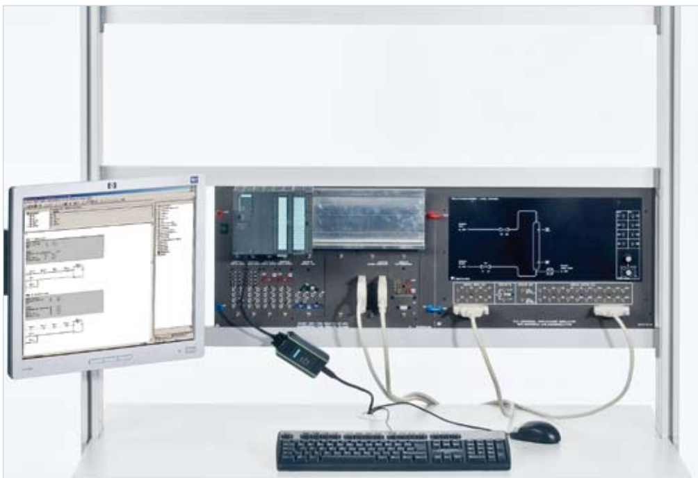
Ejemplo de experimento: "Simulador universal de instalaciones con PLC, CLC 34"
