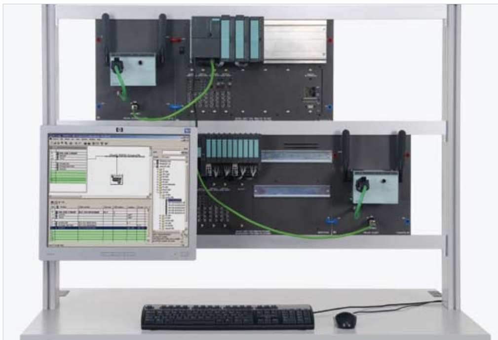
Ejemplo de experimento: "PROFINET con el complemento IWLAN CPN 1/2"
