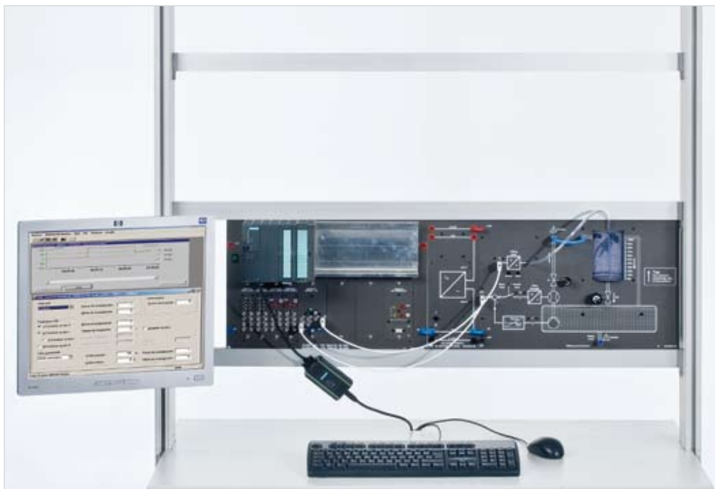
Ejemplo de experimento "Sistema controlado de nivel de llenado, CLC 36"
