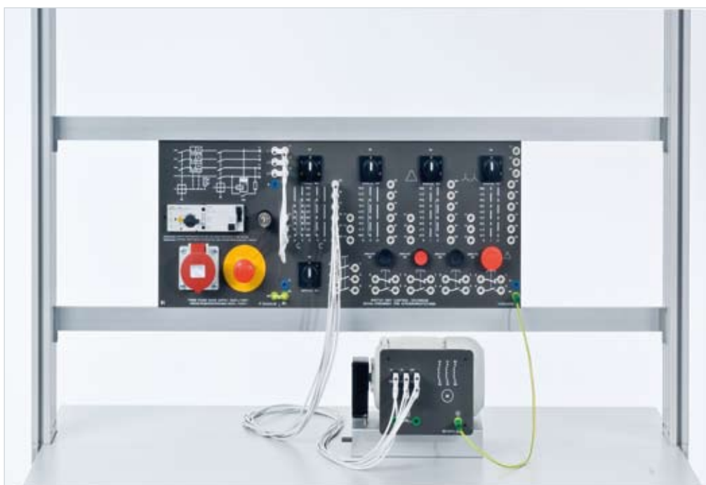
Ejemplo de experimento: "Conmutación manual en un circuito de corriente trifásica, EST 1"
