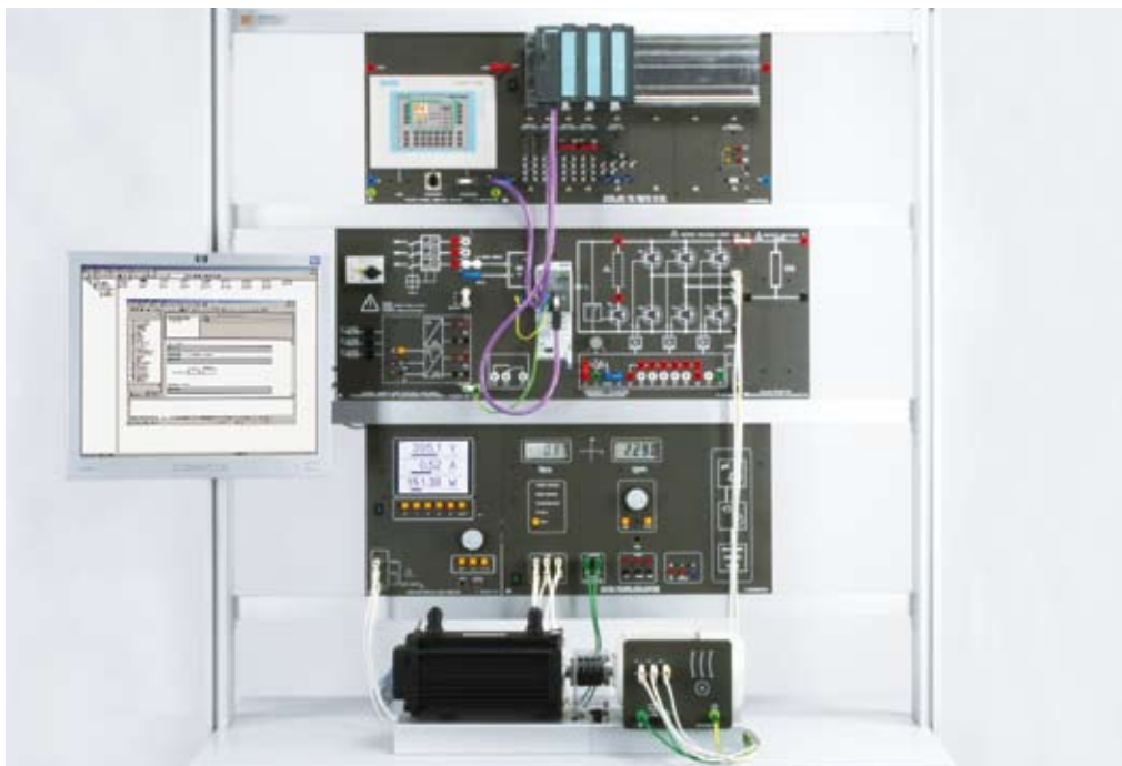
Ejemplo de experimento: "Control de sistemas de accionamiento eléctrico, CLP 20"
