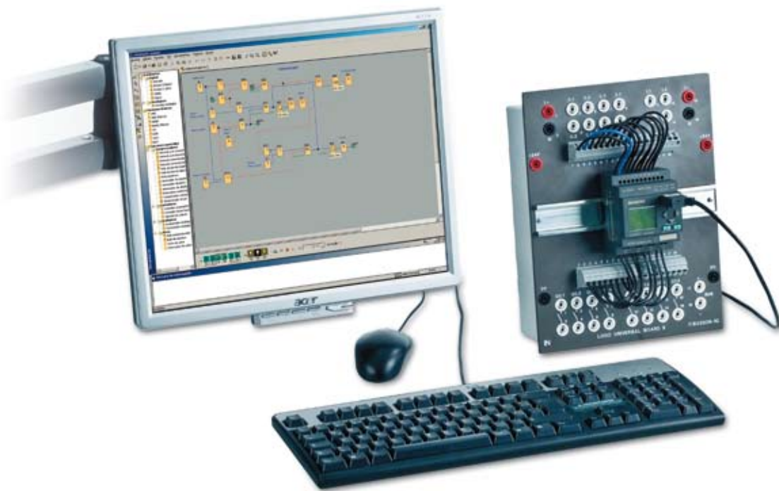
Ejemplo de experimento: "Pequeña unidad de control programable LOGO!®, EST 4"
