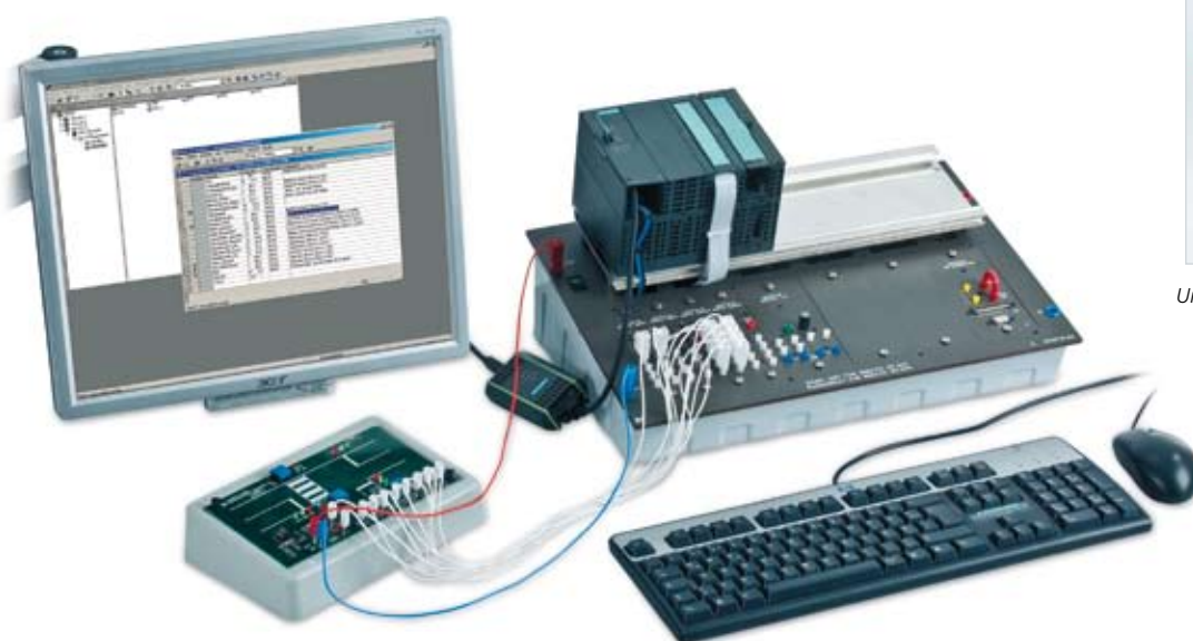
Ejemplo de experimento: "Modelo de tarjeta PLC para semáforo de tráfico, CLC 33"
