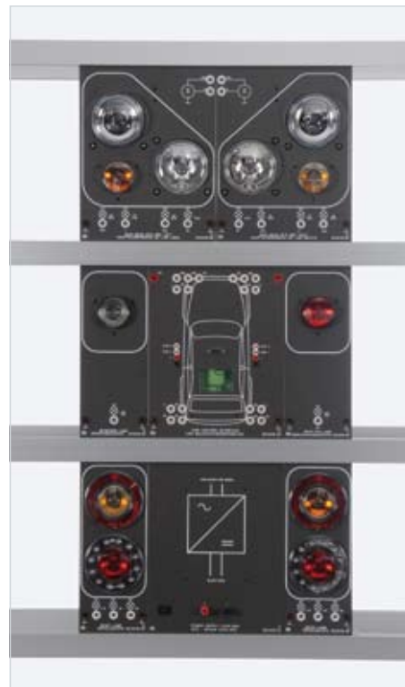
Versuch „CAN-Bus-gesteuerte Fahrzeugbeleuchtung“ mit Interface SO3216-2Z und Zusatzkomponenten
