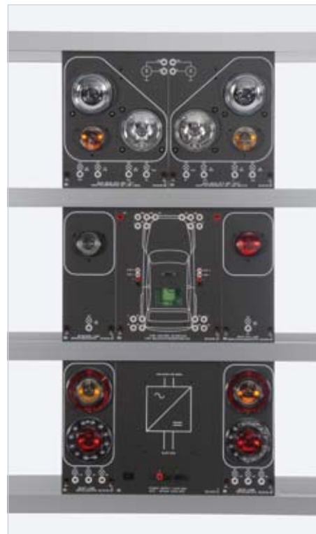
Versuch „CAN-Bus-gesteuerte Fahrzeugbeleuchtung“ mit Interface SO3216-2Z und Zusatzkomponenten
