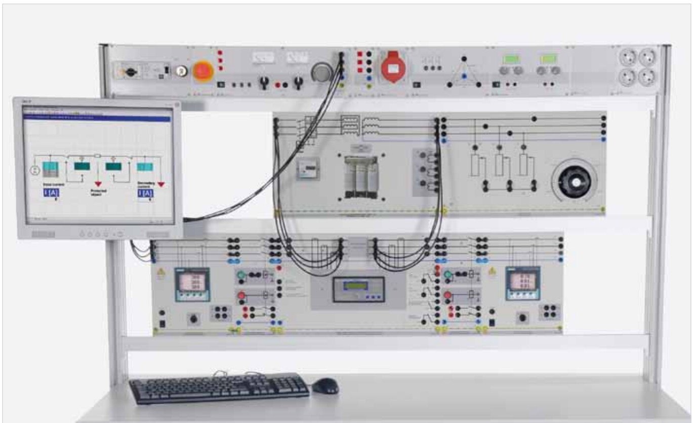
Versuchsbeispiel „Transformator-Differentialschutz ETP 1“
