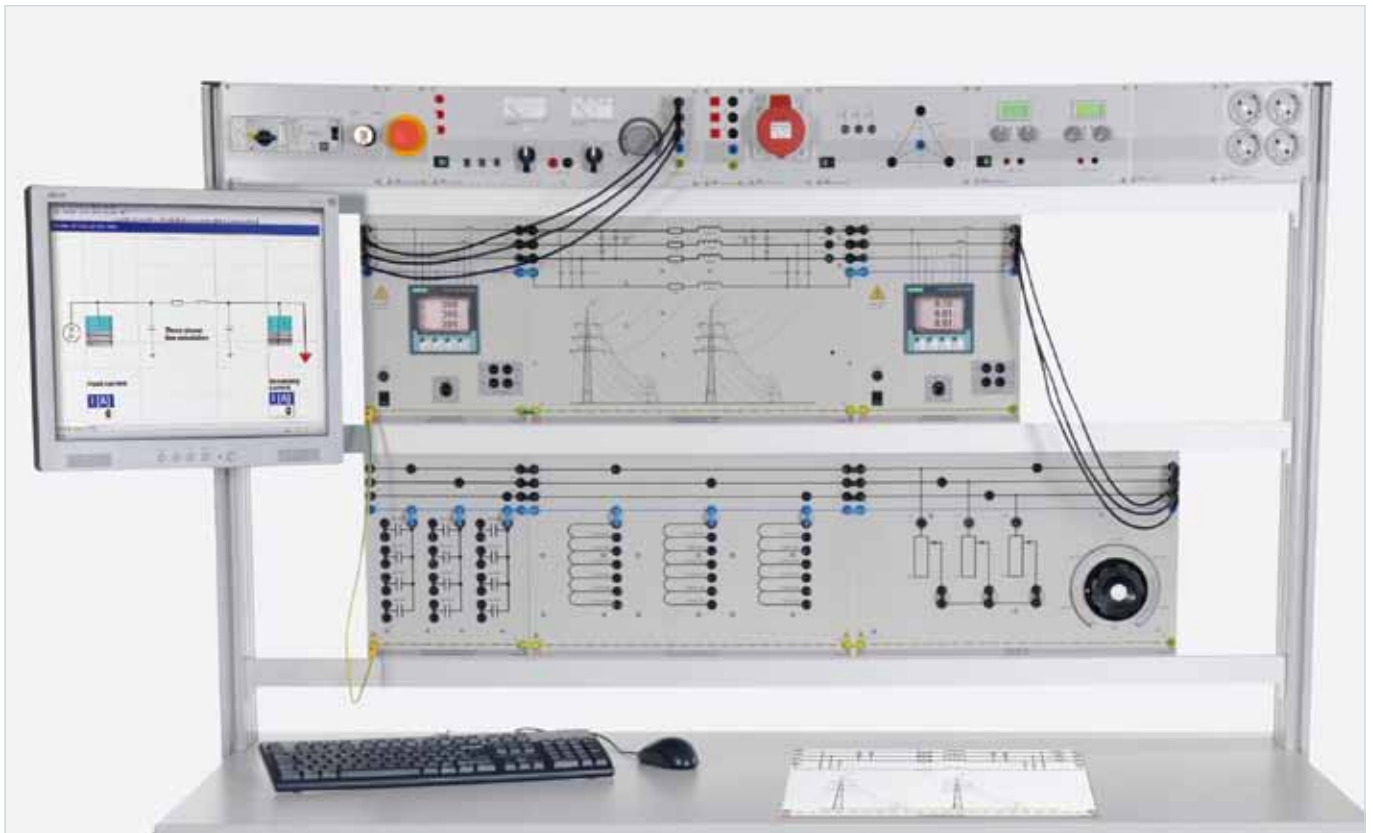
Versuchsbeispiel „Untersuchungen an Drehstromleitungen EUL 1“
