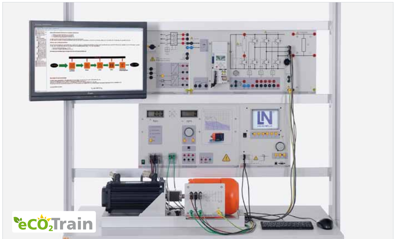
Trainingsystem „Energieeffiziente Antriebe mit Frequenzumrichtern“ bestehend aus Höchsteffizienzmotor, Frequenzumrichter und Servo-Maschinenprüfstand“ EEM11.3
