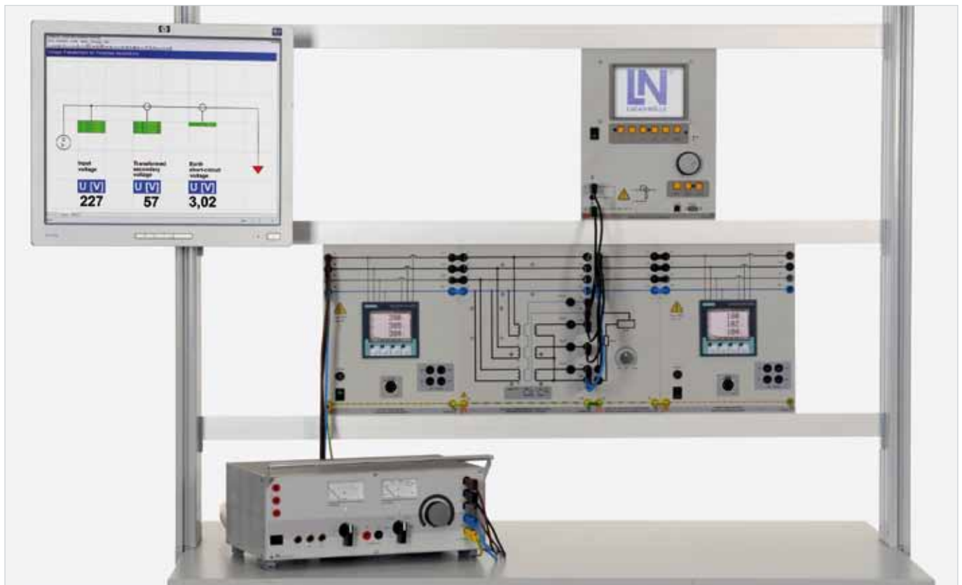
Versuchsbeispiel „Spannungswandler EUB 2“
