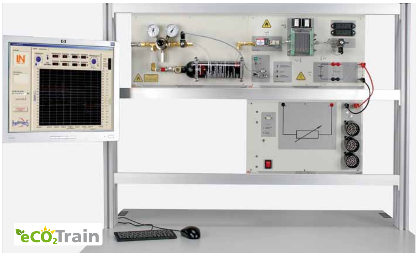
Versuchsbeispiel „50-VA-Brennstoffzellen-Stack mit Verbrauchern EHY 1“
