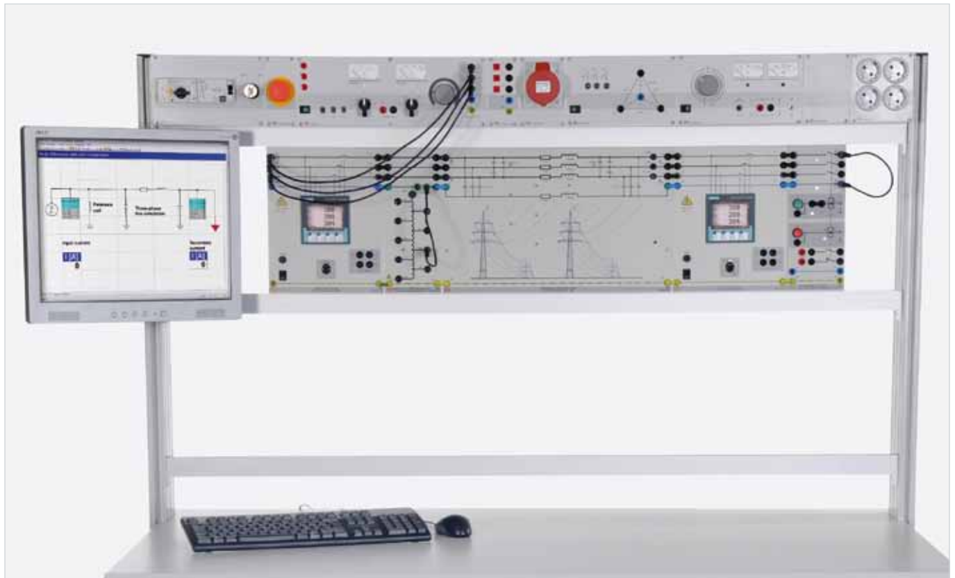
Versuchsbeispiel „Untersuchungen an Leitungen mit Erdschlusskompensation EUL 3“
