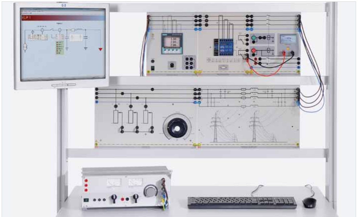
Versuchsbeispiel „Überstromzeitschutz für Leitungen ELP 1“
