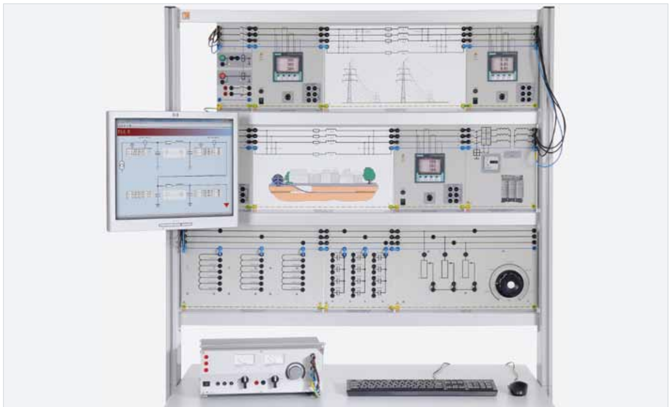
Versuchsbeispiel „ Verbundnetze aus Kabeln und Leitungen EUL6“
