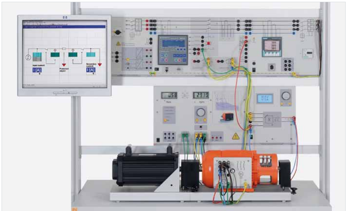
Versuchsbeispiel „Generatorschutz EGP 1“
