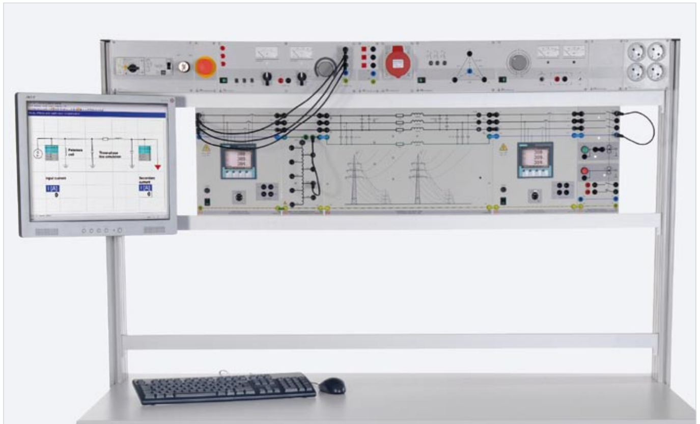
Versuchsbeispiel „Untersuchungen an Leitungen mit Erdschlusskompensation EUL 3“
