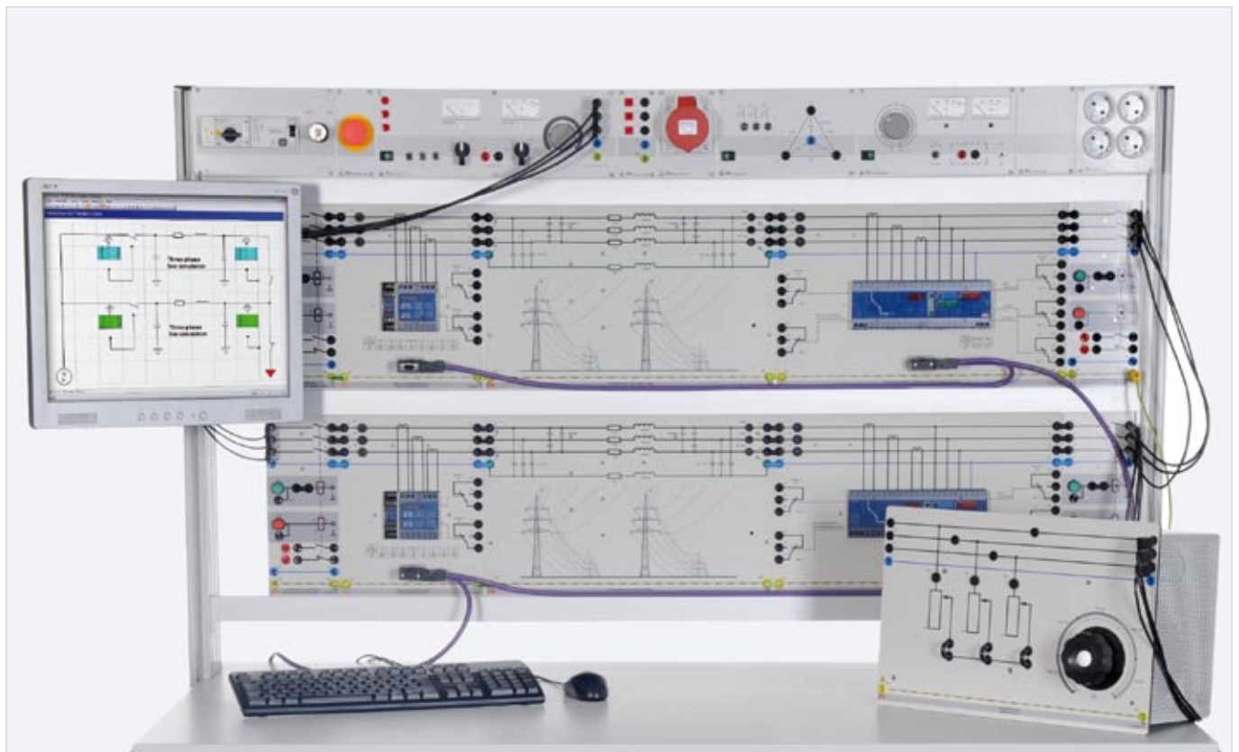
Versuchsbeispiel „Schutz paralleler Leitungen ELP 6“
