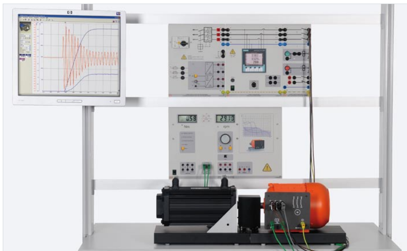
Versuchsbeispiel „Untersuchungen an dynamischen Verbraucher EUC 2“
