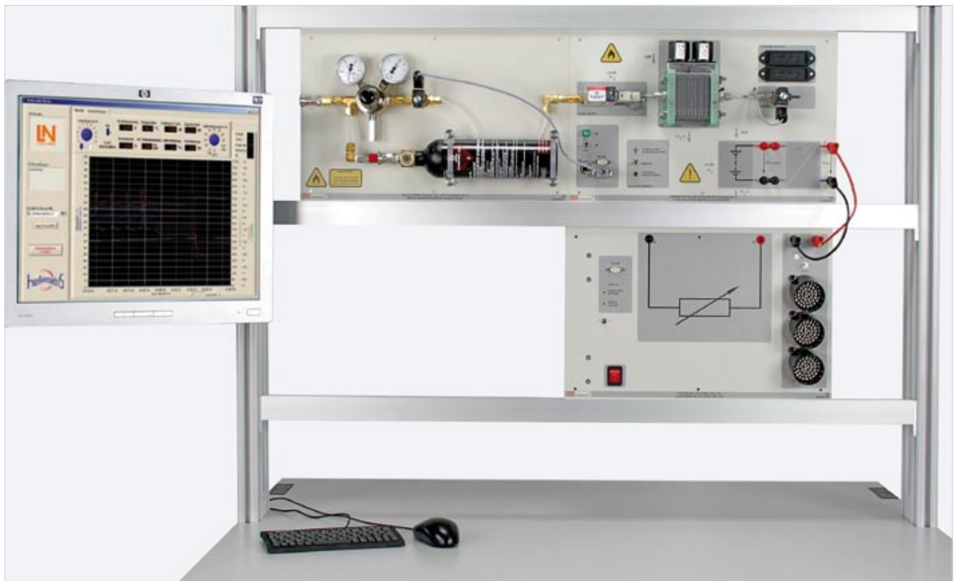
Versuchsbeispiel „50-VA-Brennstoffzellen-Stack mit Verbrauchern EHY 1“
