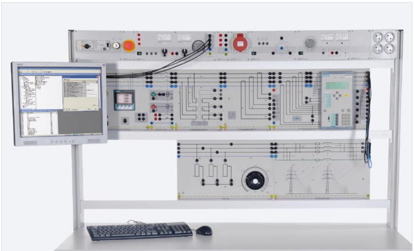
Versuchsbeispiel „Schnelldistanzschutz ELP 7“
