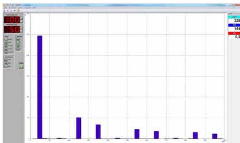
Oberwellenanalyse bei Blockkommutierung
