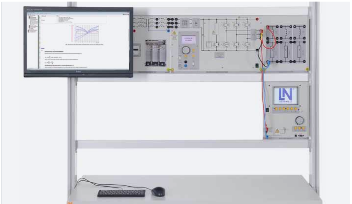
Trainingssystem „Selbstgeführte Stromrichter mit passiver R-L-Last“
