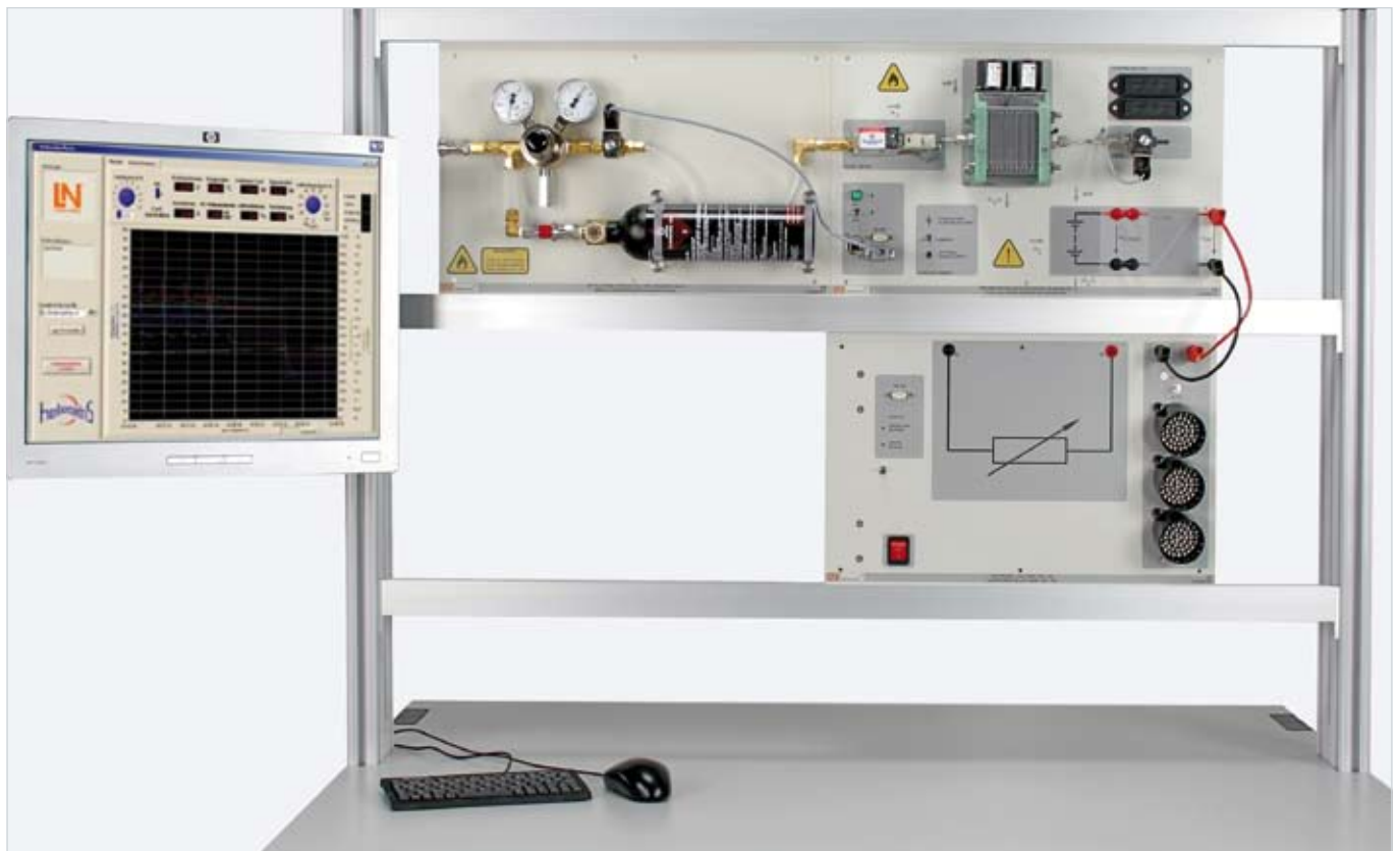
Versuchsbeispiel „50 VA-Brennstoffzellen-Stack mit Verbrauchern“ EHY1
