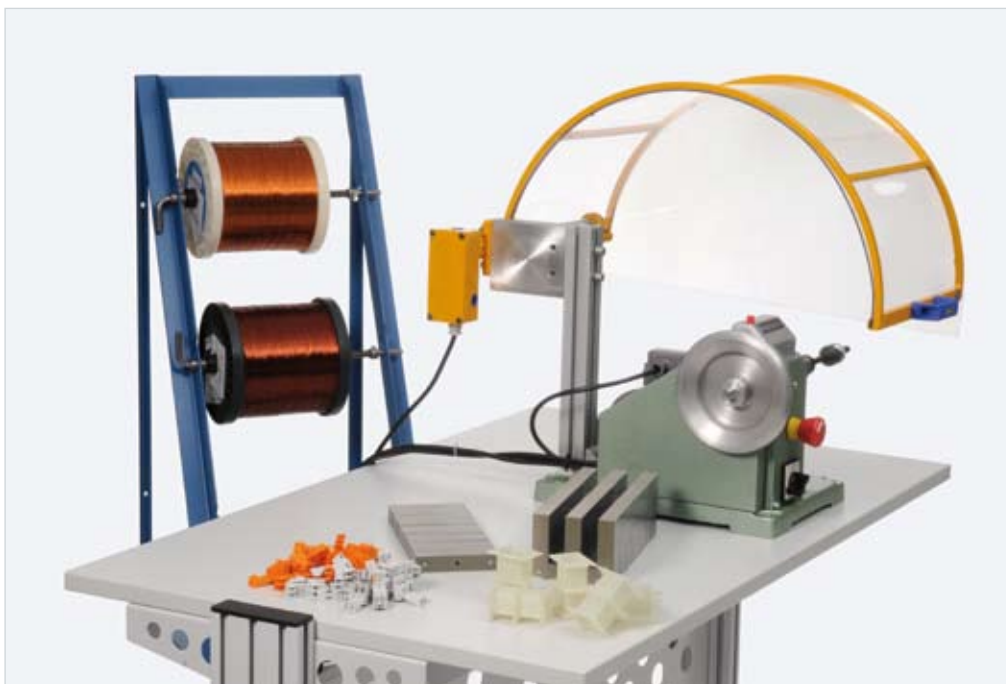
Versuchsbeispiel: „Wickeln von Transformatoren EMW 10“
