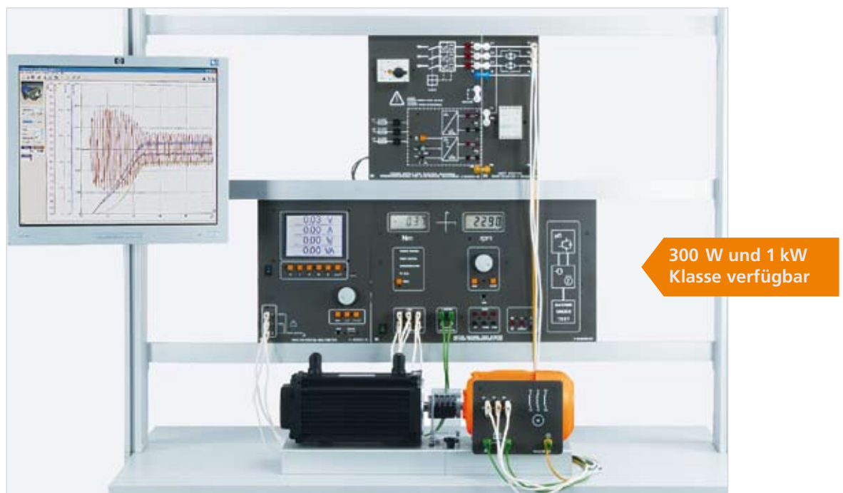
Versuchsbeispiel „Sanftanlauf an Drehstrommaschinen EDT 17“
