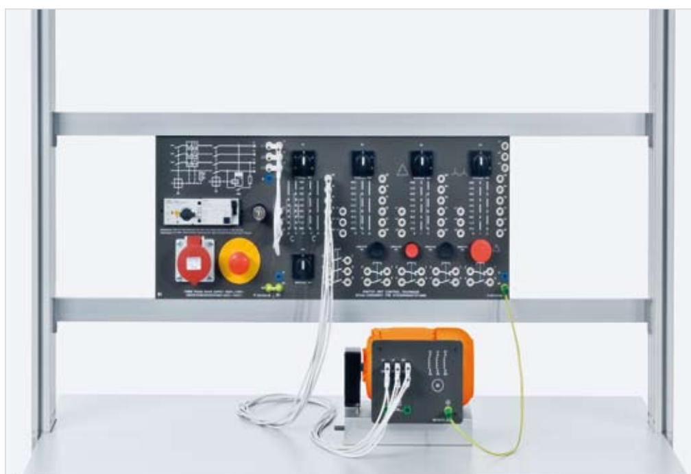
Versuchsbeispiel „Handbetätigtes Schalten im Drehstromkreis EST 1“
