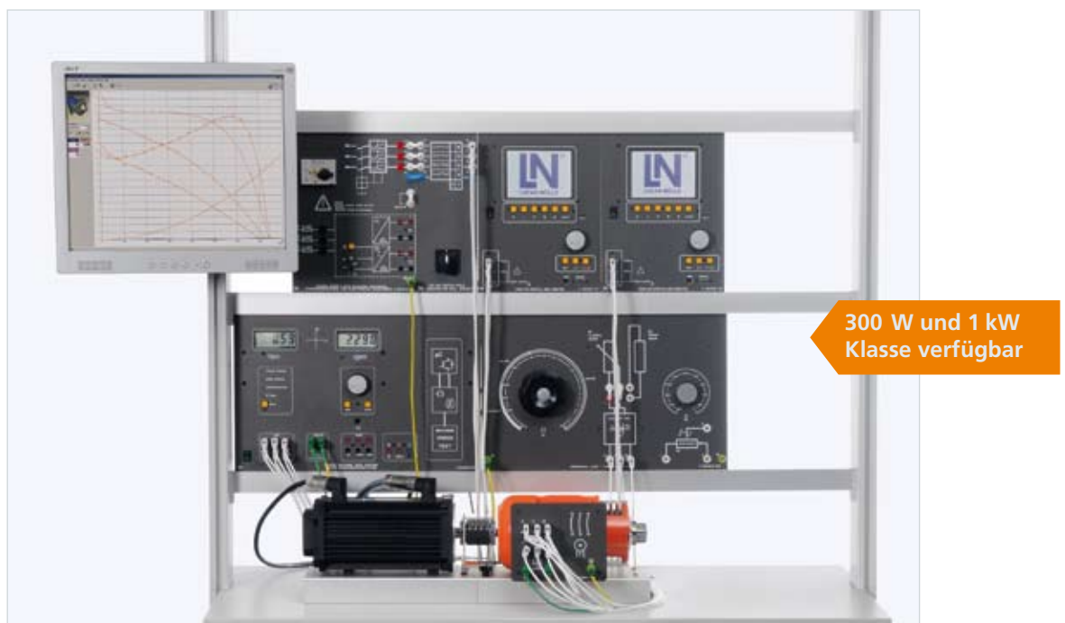
Versuchsbeispiel „Drehstrommotor mit Schleifringen EEM 4.4“
