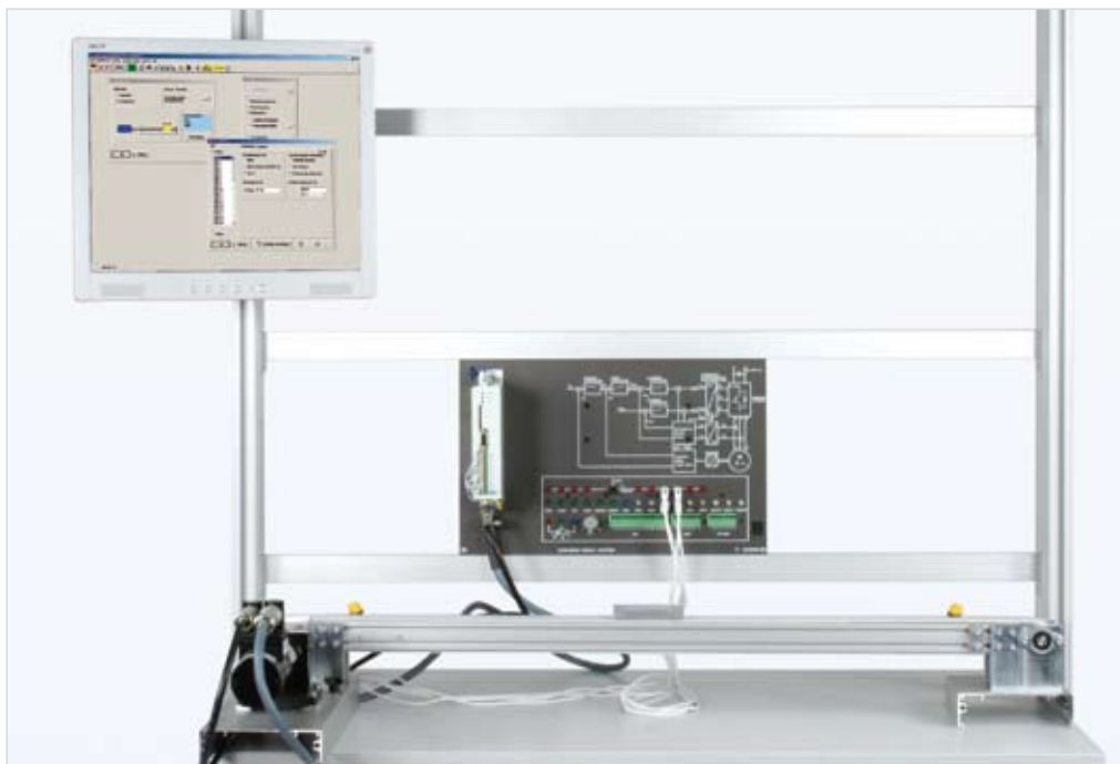
Versuchsbeispiel „Positionieren mit Synchron-Servo-System EDT 32“
