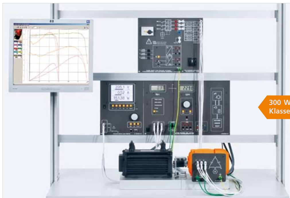
Versuchsbeispiel „Drehstrommotor polumschaltbar nach Dahlander EEM 4.2“
