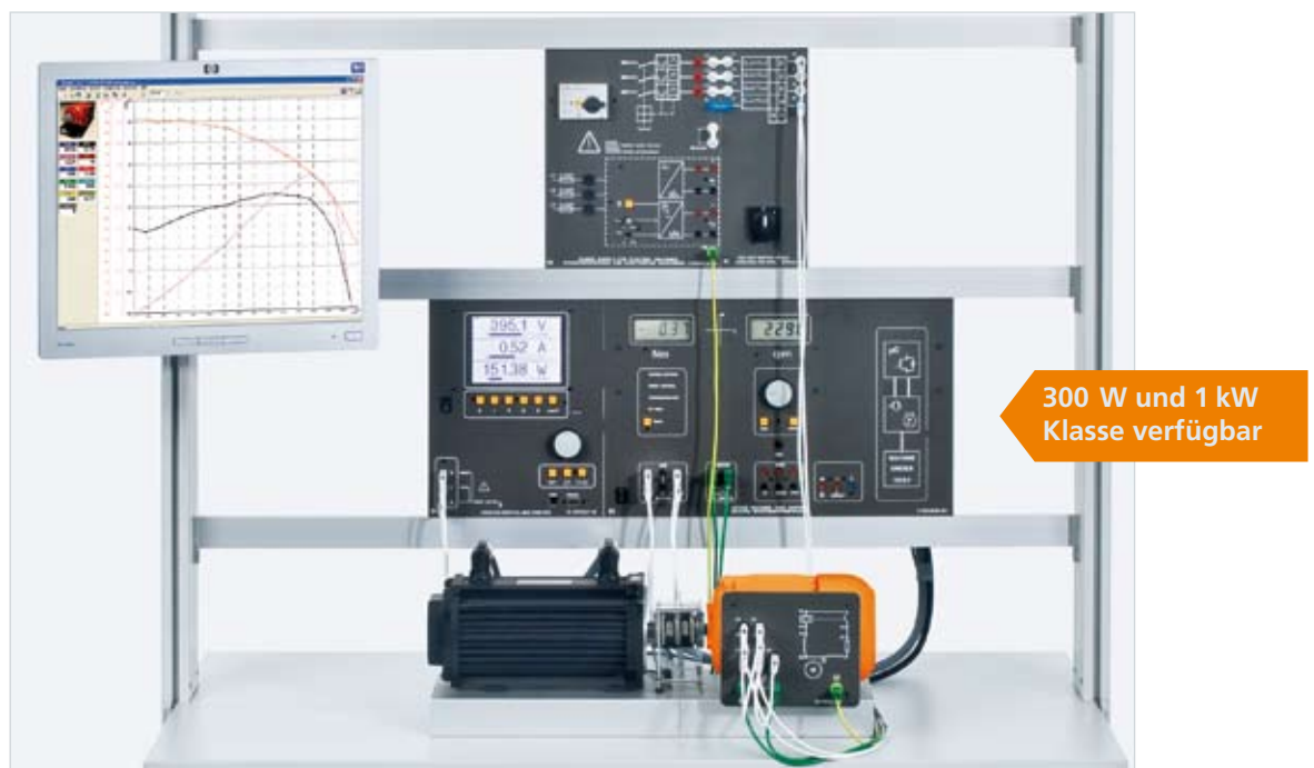
Versuchsbeispiel „Einphasenmotor mit Bifilar-Anlaufwicklung EEM 3.3“
