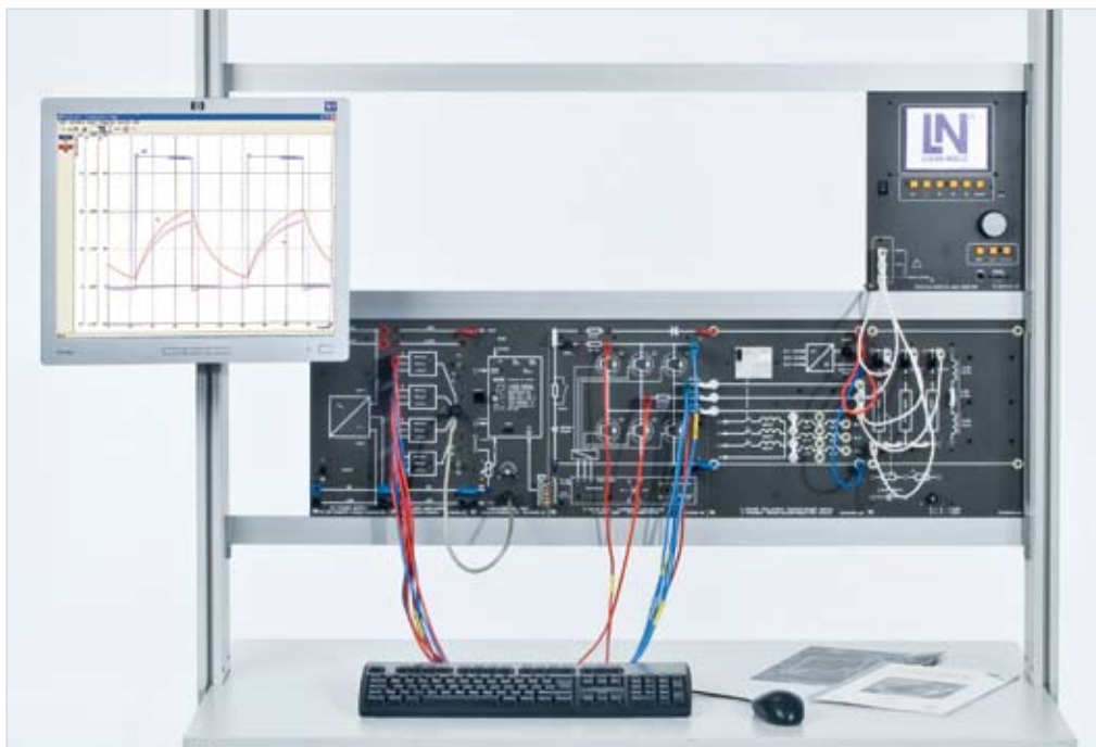
Versuchsbeispiel „Selbstgeführte Stromrichter EPE 20“
