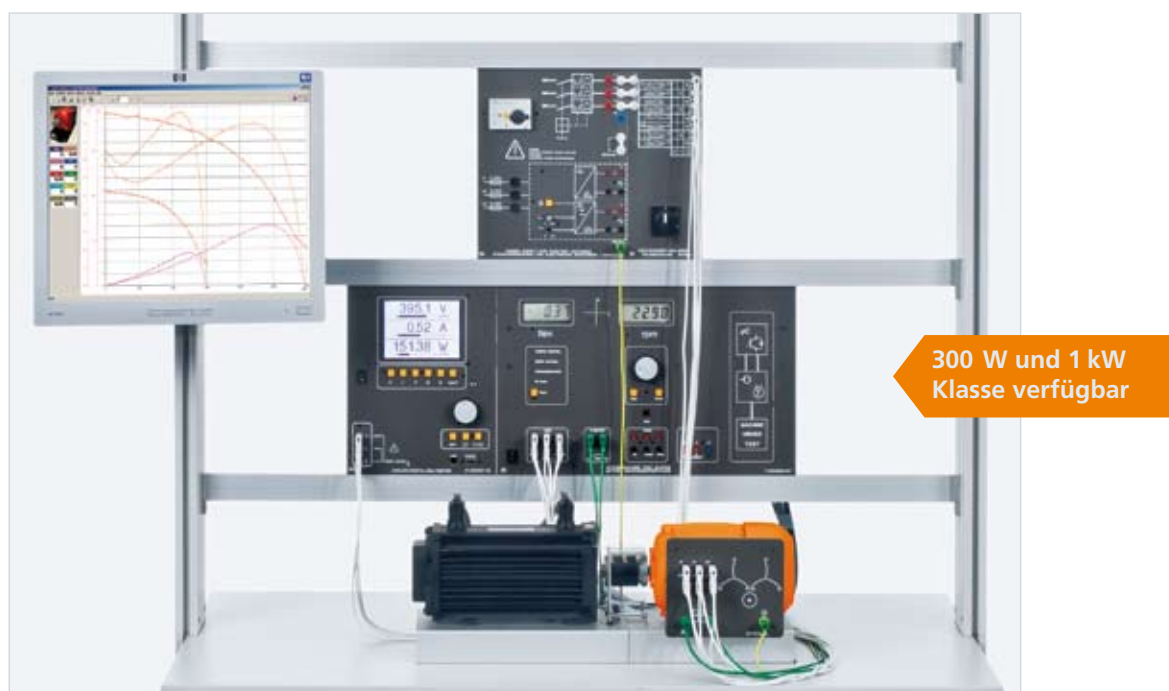
Versuchsbeispiel „Drehstrommotor polumschaltbar zwei getrennte Wicklungen EEM 4.3“
