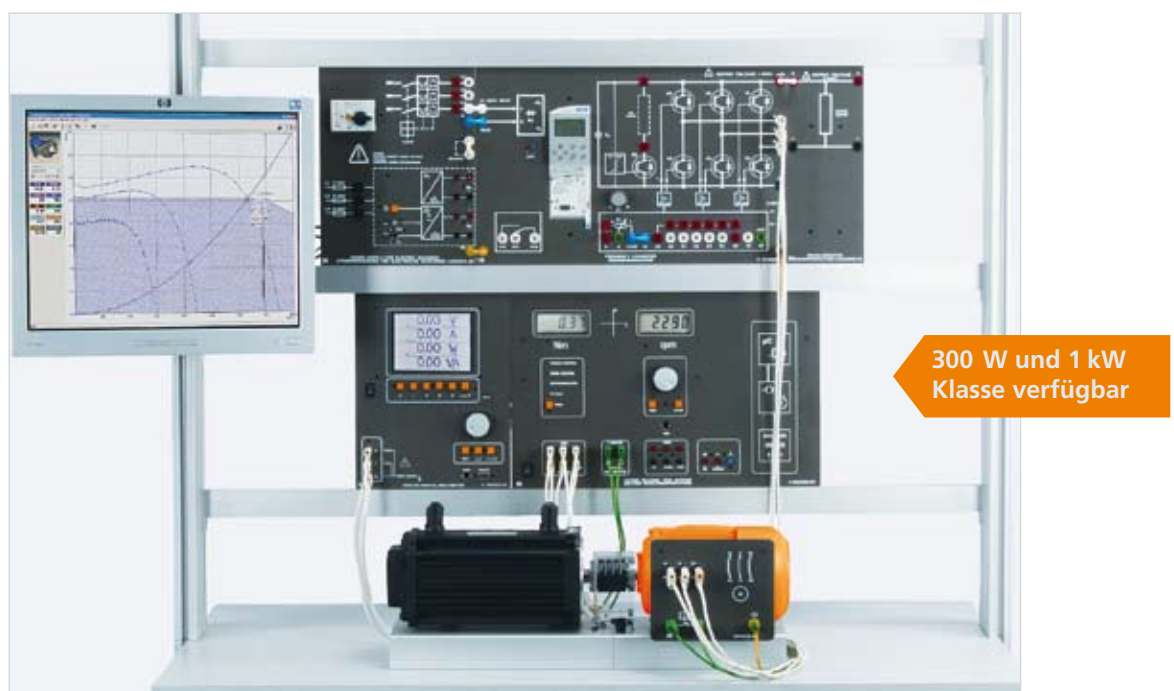
Versuchsbeispiel „Antriebe mit Frequenzumrichter EDT 25“
