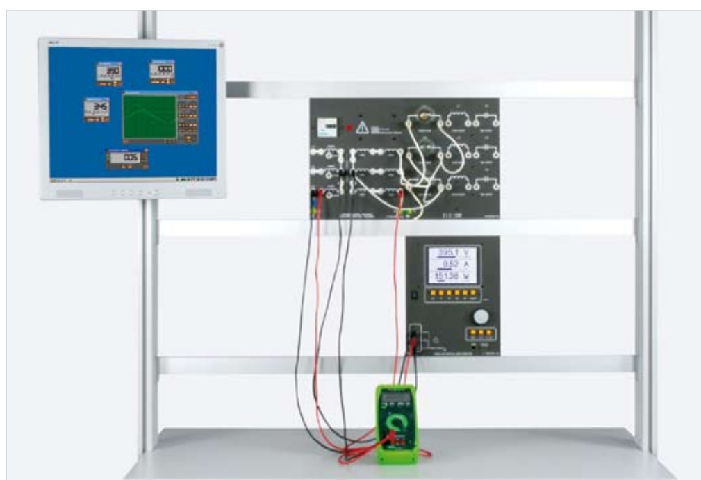
Versuchsbeispiel „Ein- und Dreiphasentransformatoren ENT 5“
