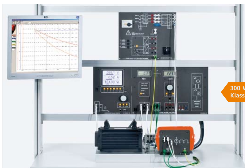
Versuchsbeispiel „Universalmotor EEM 3.1“
