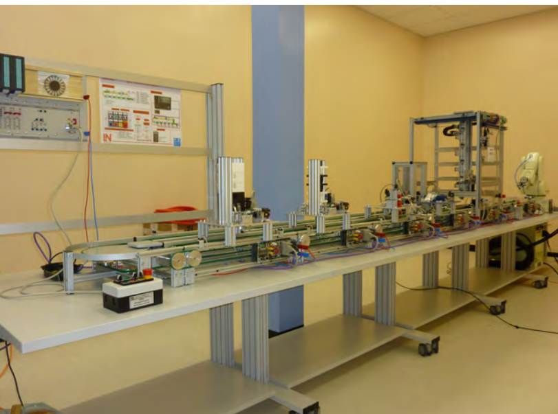
Realistischer geht es nicht: Automatisierungstechnik in der Ausbildung mit der IMS®-Anlage
