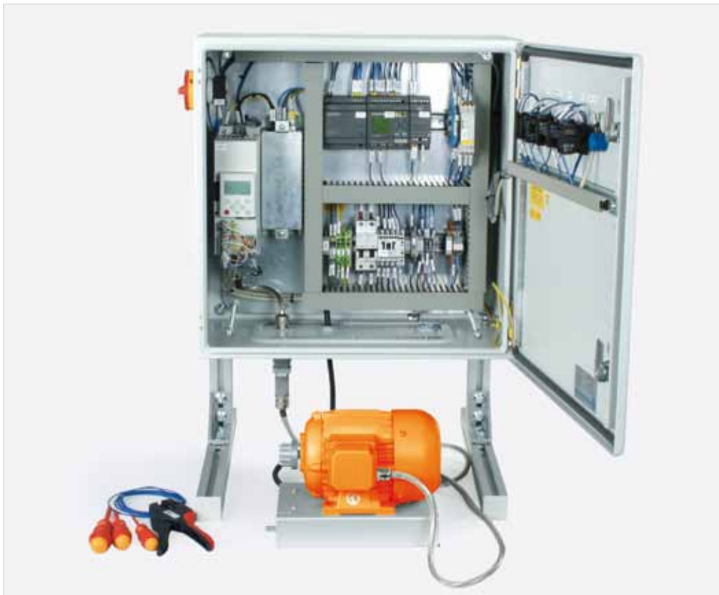
Versuchsbeispiel „Projektarbeit Frequenzumrichter EPL 25“
