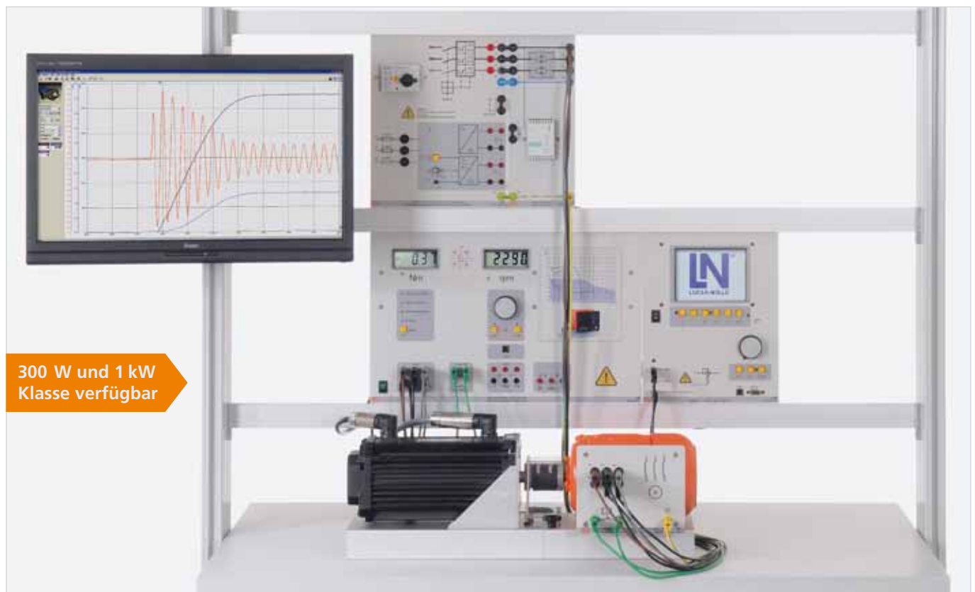
Versuchsbeispiel „Sanftanlauf an Drehstrommaschinen EDT 17“
