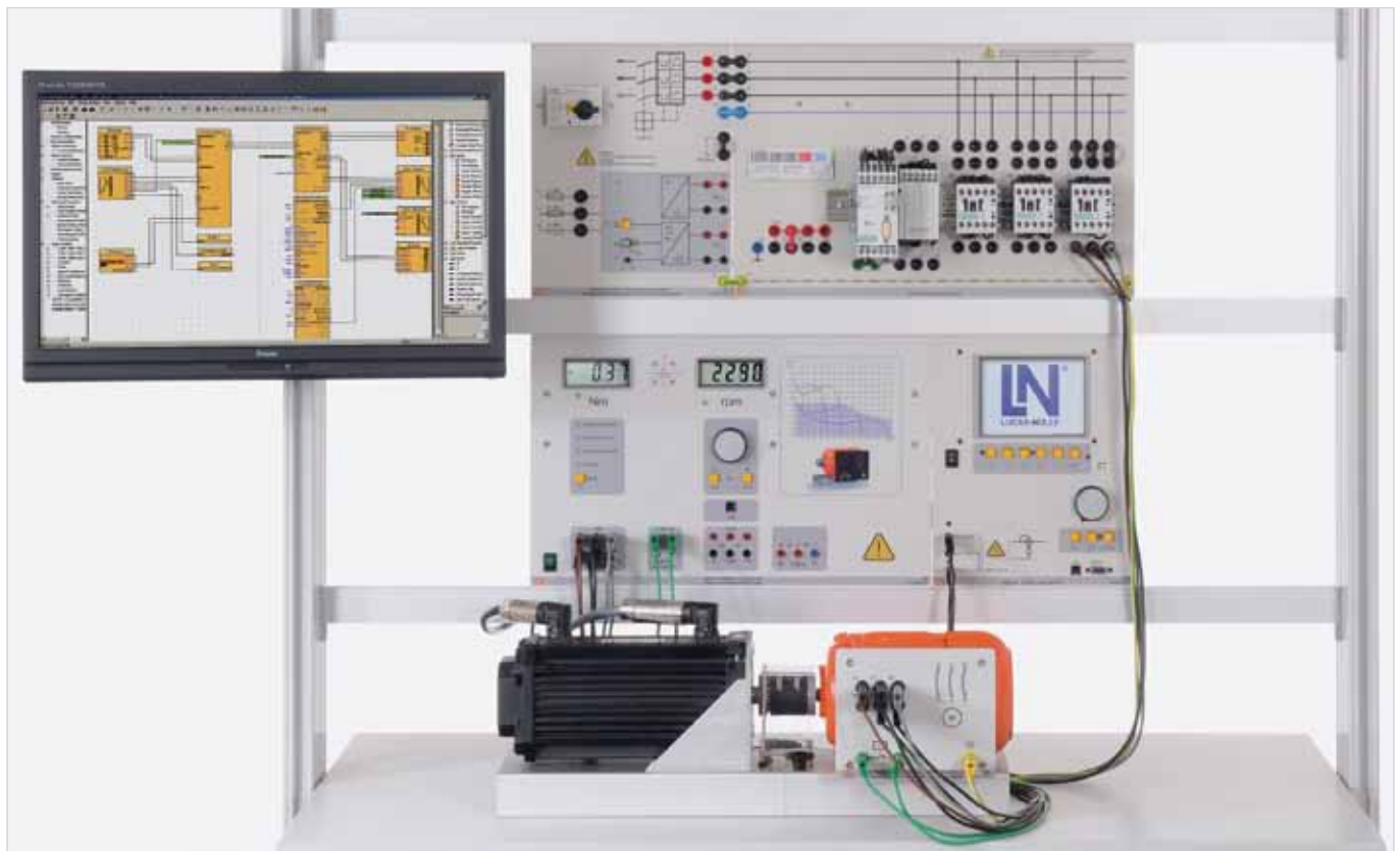
Versuchsbeispiel „Motormanagementrelais EDT 51“
