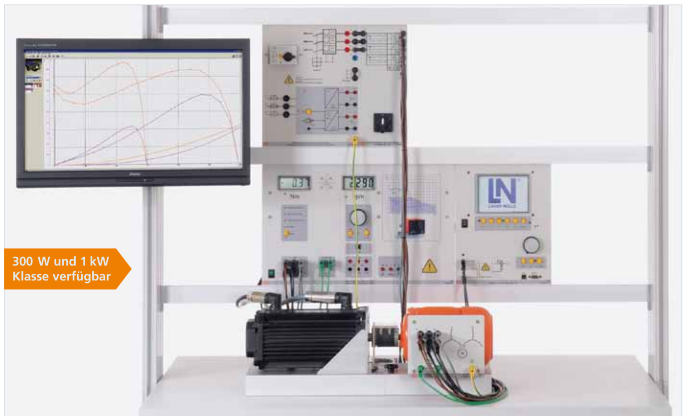
Versuchsbeispiel „Drehstrommotor polumschaltbar zwei getrennte Wicklungen EEM 4.3“
