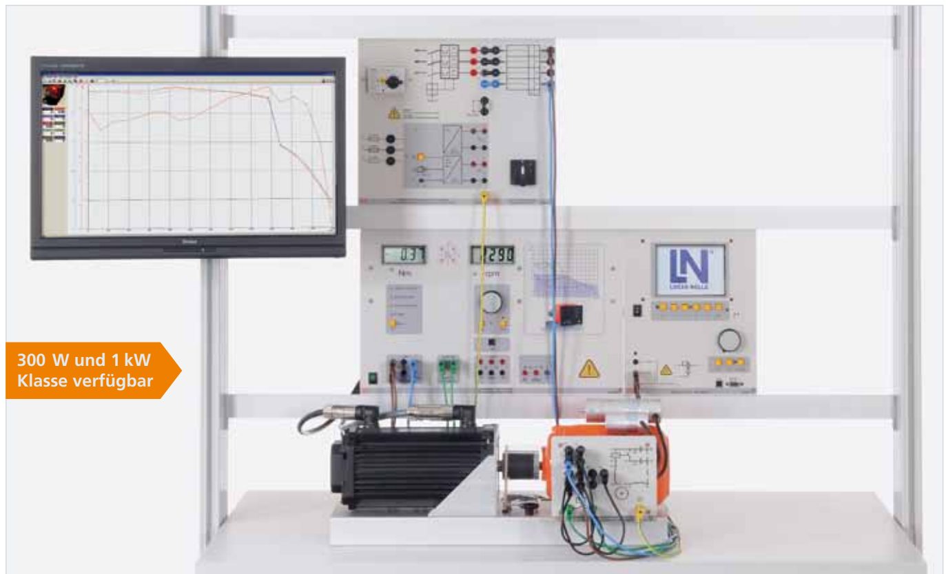
Versuchsbeispiel „Einphasenmotor mit Betriebs- und Hilfskondensator EEM 3.4“
