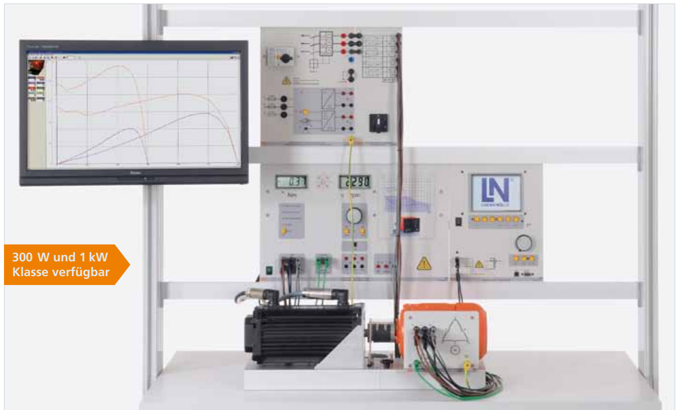
Versuchsbeispiel „Drehstrommotor polumschaltbar nach Dahlander EEM 4.2“
