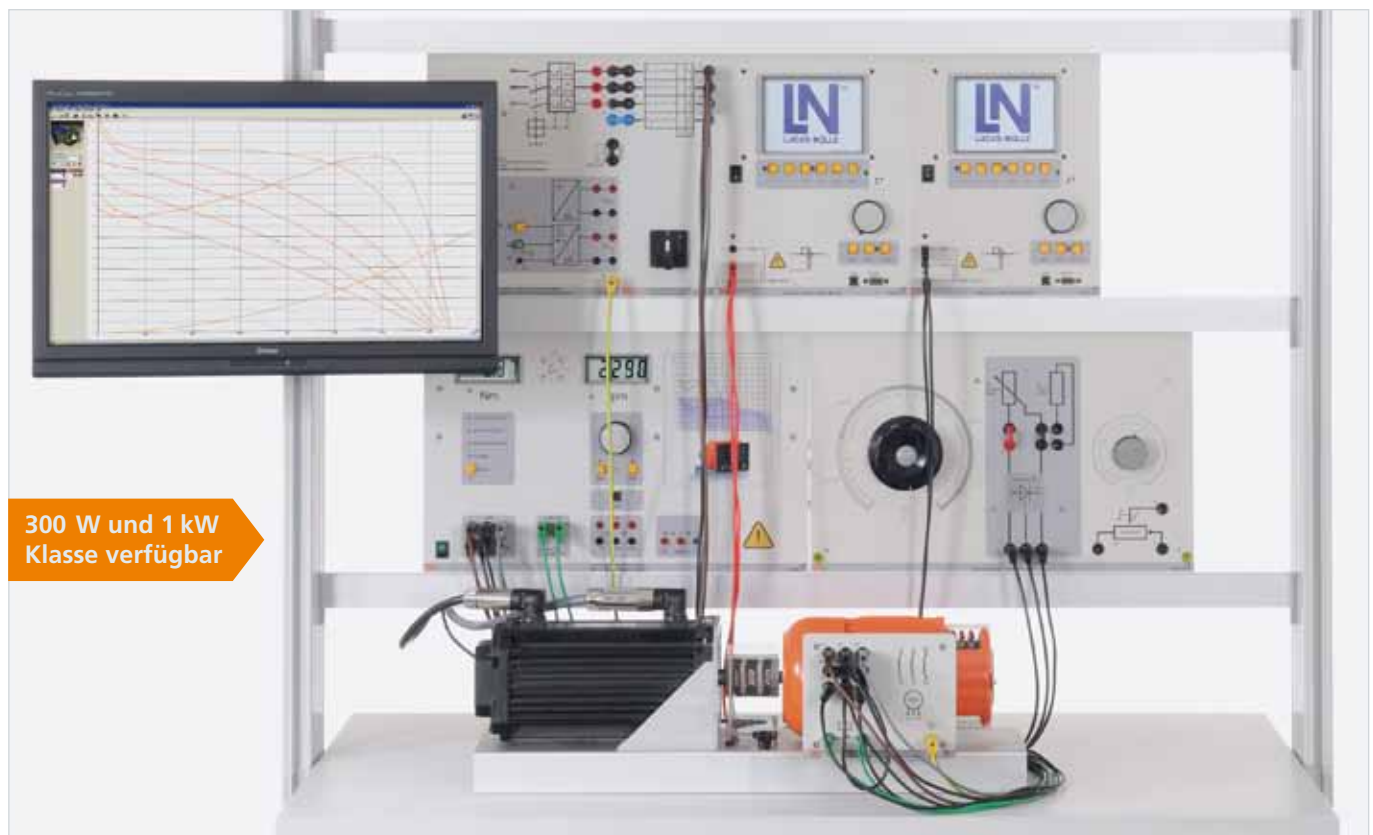
Versuchsbeispiel „Drehstrommotor mit Schleifringen EEM 4.4“
