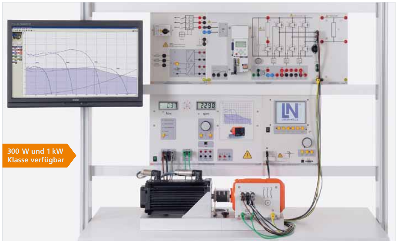
Versuchsbeispiel „Antriebe mit Frequenzumrichter EDT 25“
