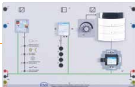
Ergänzungsboard EIT 8.3: Heizungssteuerung
