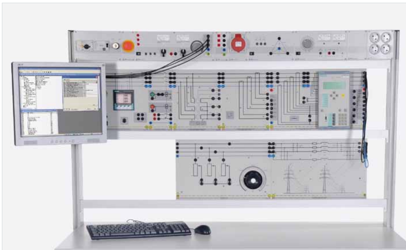
Ejemplo de experimento: "Protección instantánea a distancia, ELP 7"
