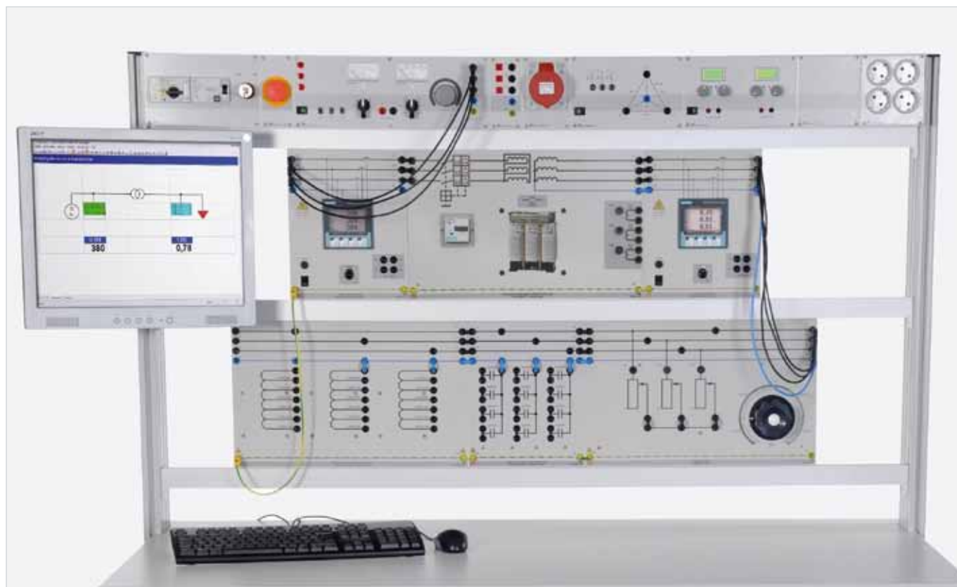
Ejemplo de experimento: "Análisis de transformadores, EUT"
