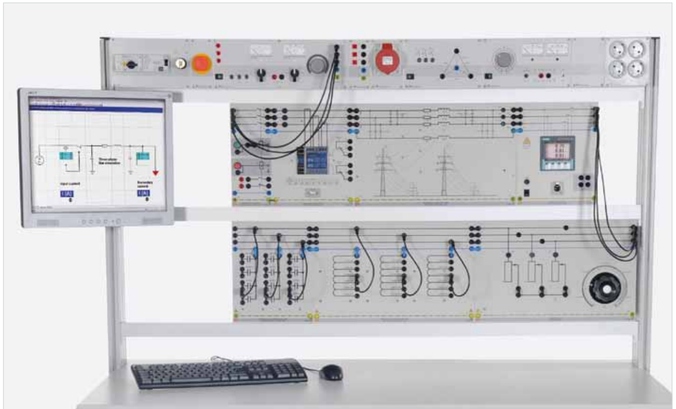
Ejemplo de experimento: "Protección temporizada de líneas contra sobreintensidad de corriente, ELP 1"
