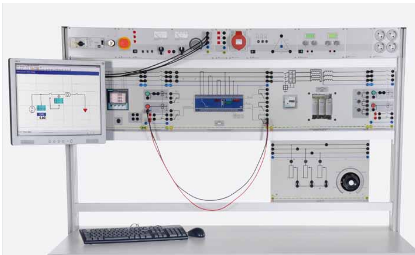
Ejemplo de experimento: "Protección temporizada contra sobreintensidad de corriente, ETP 2"
