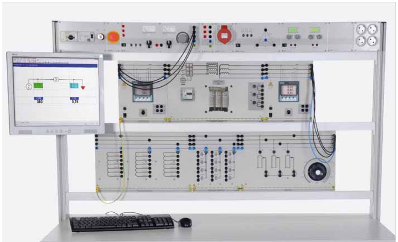
Versuchsbeispiel „Untersuchungen an Transformatoren EUT“
