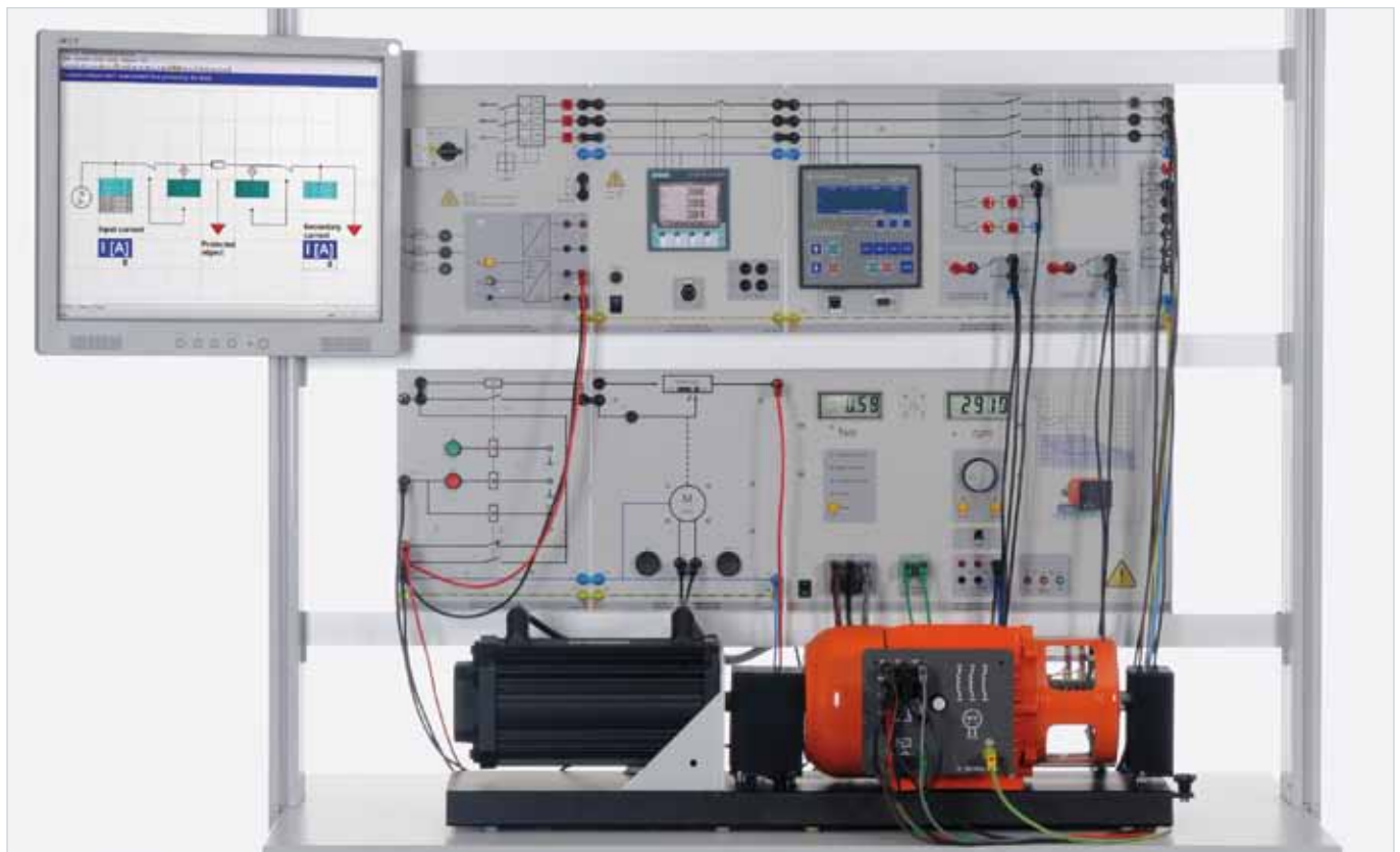
Versuchsbeispiel „Generatorschutz EGP 1“
