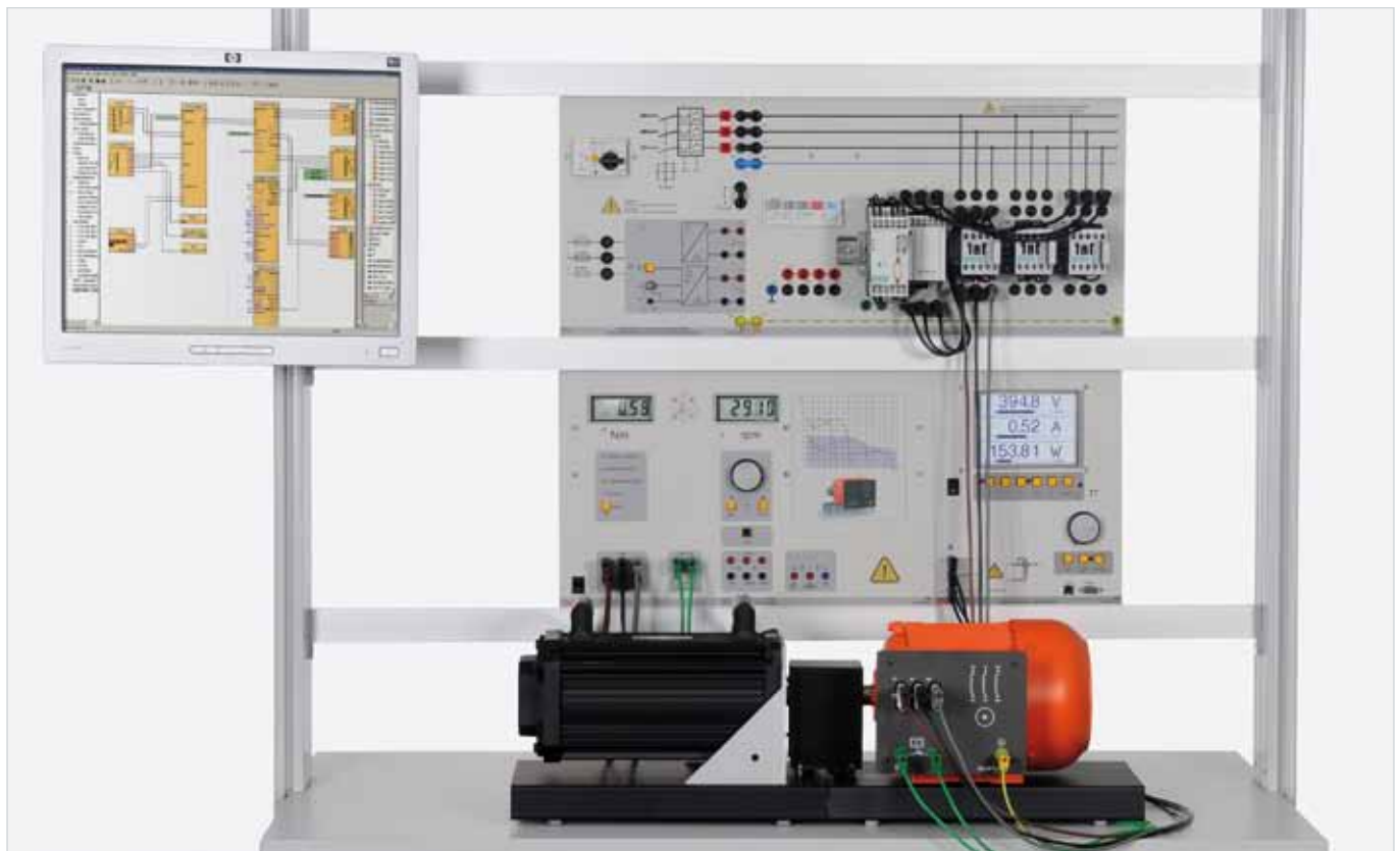
Versuchsbeispiel „Motormanagementrelais EDT 51“
