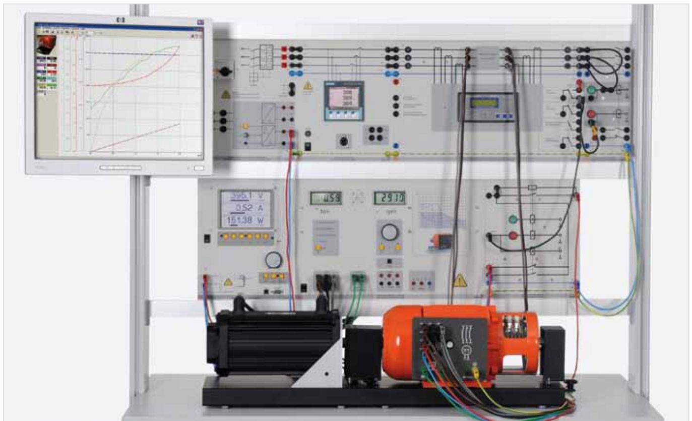
Versuchsbeispiel „Generator-Differentialschutz EGP 2“
