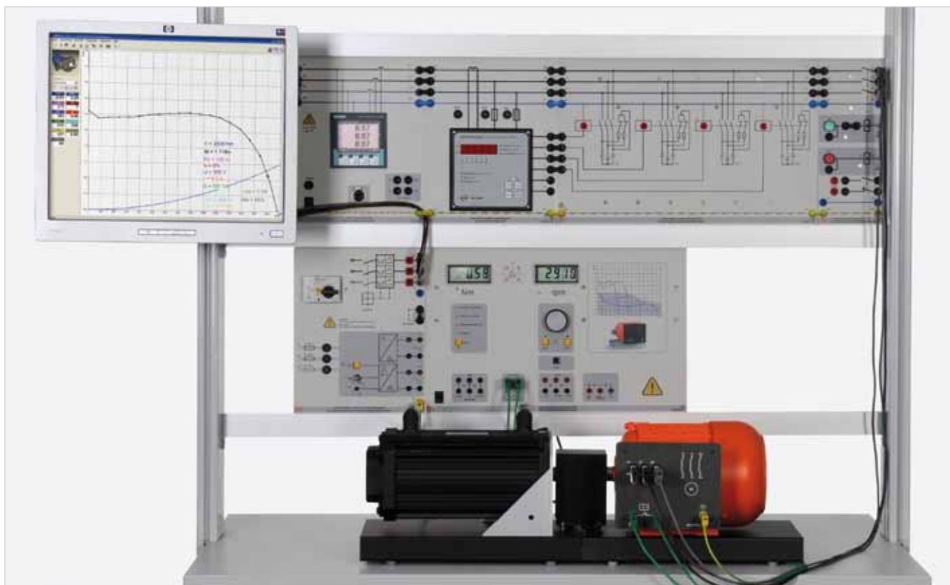
Versuchsbeispiel „automatische Blindleistungskompensation EUC 3“
