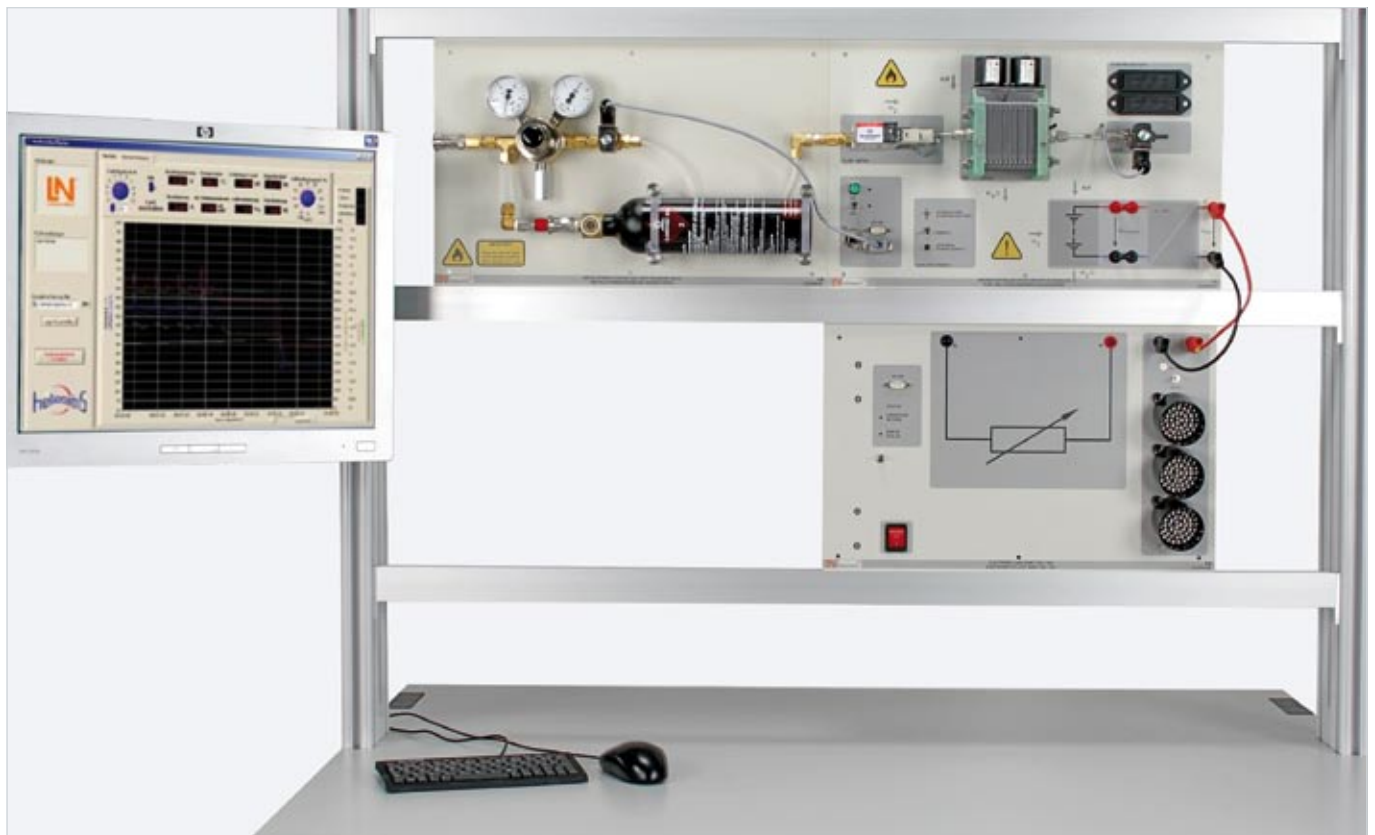
Exemple d'expérience « Bloc de piles à combustible 50 VA avec consommateurs » EHY1
