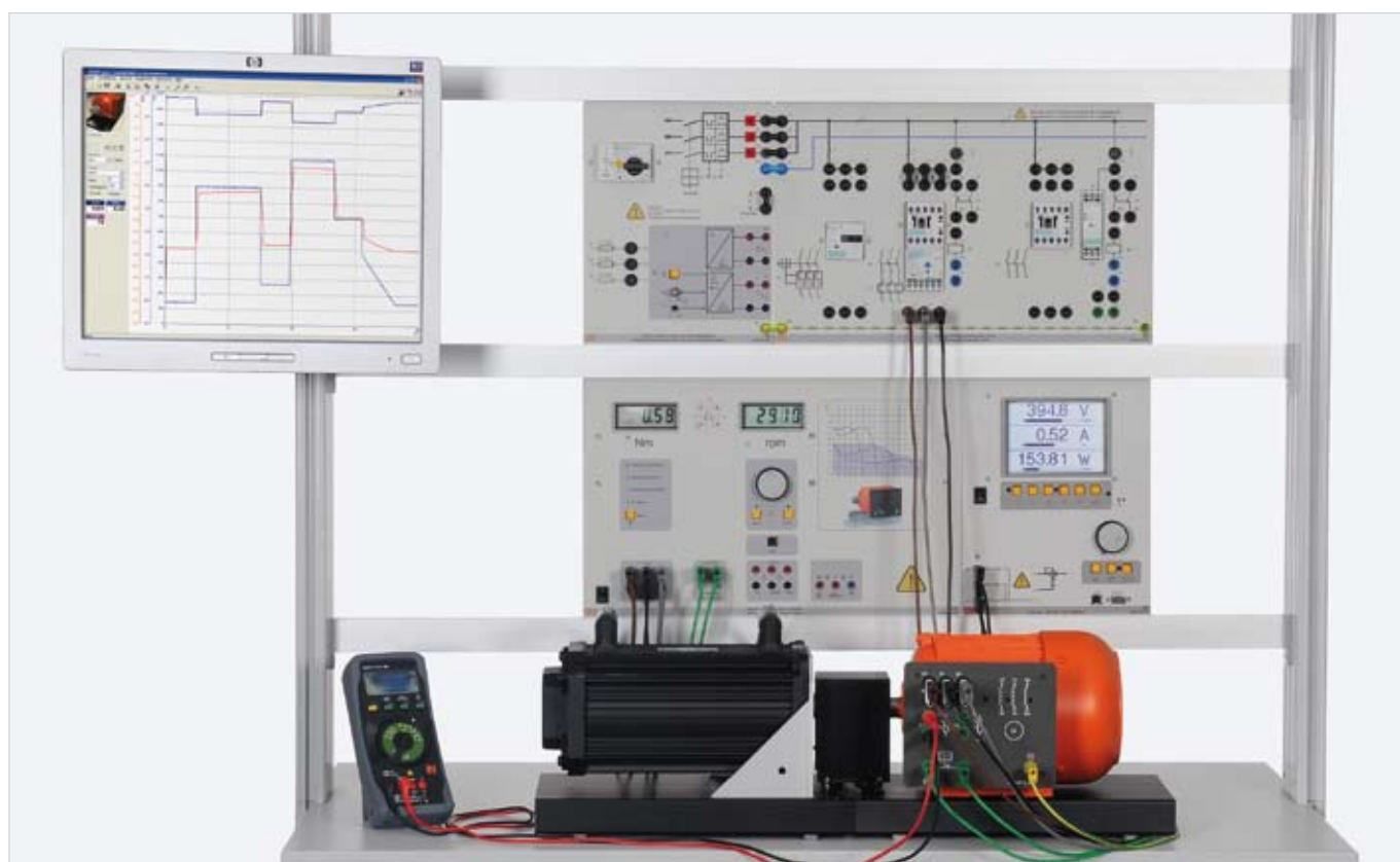
Príklad zapojenia „Ochrana elektrických strojov EEM 4.6“
