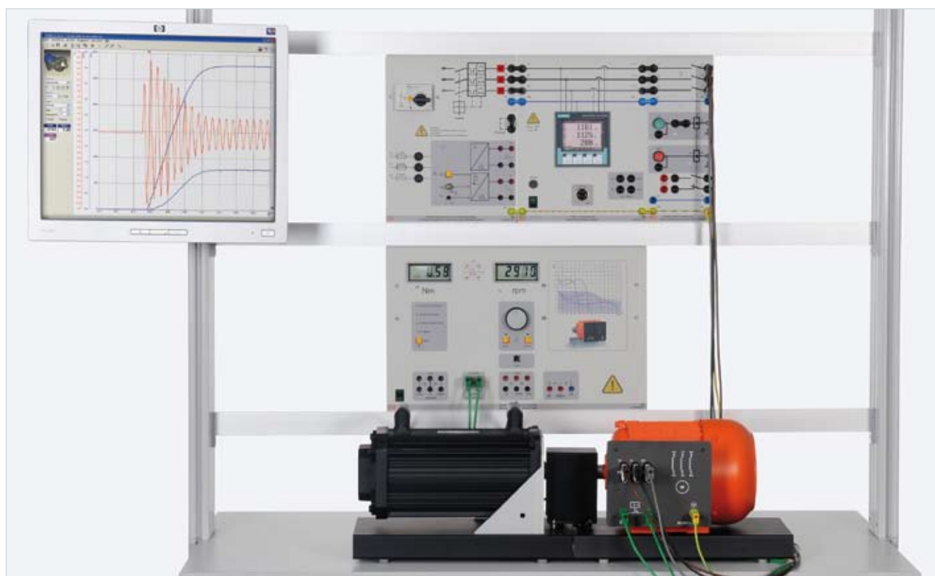
Príklad zapojenia „Vyšetovanie dynamického spotrebiča EUC 2“
