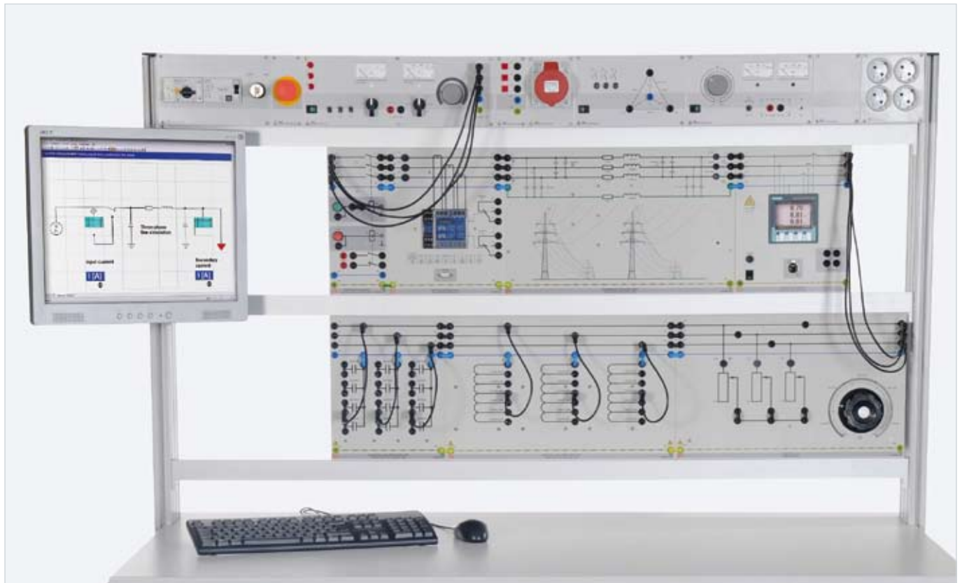
Príklad zapojenia „Nadprúdová časová ochrana vedení ELP 1“
