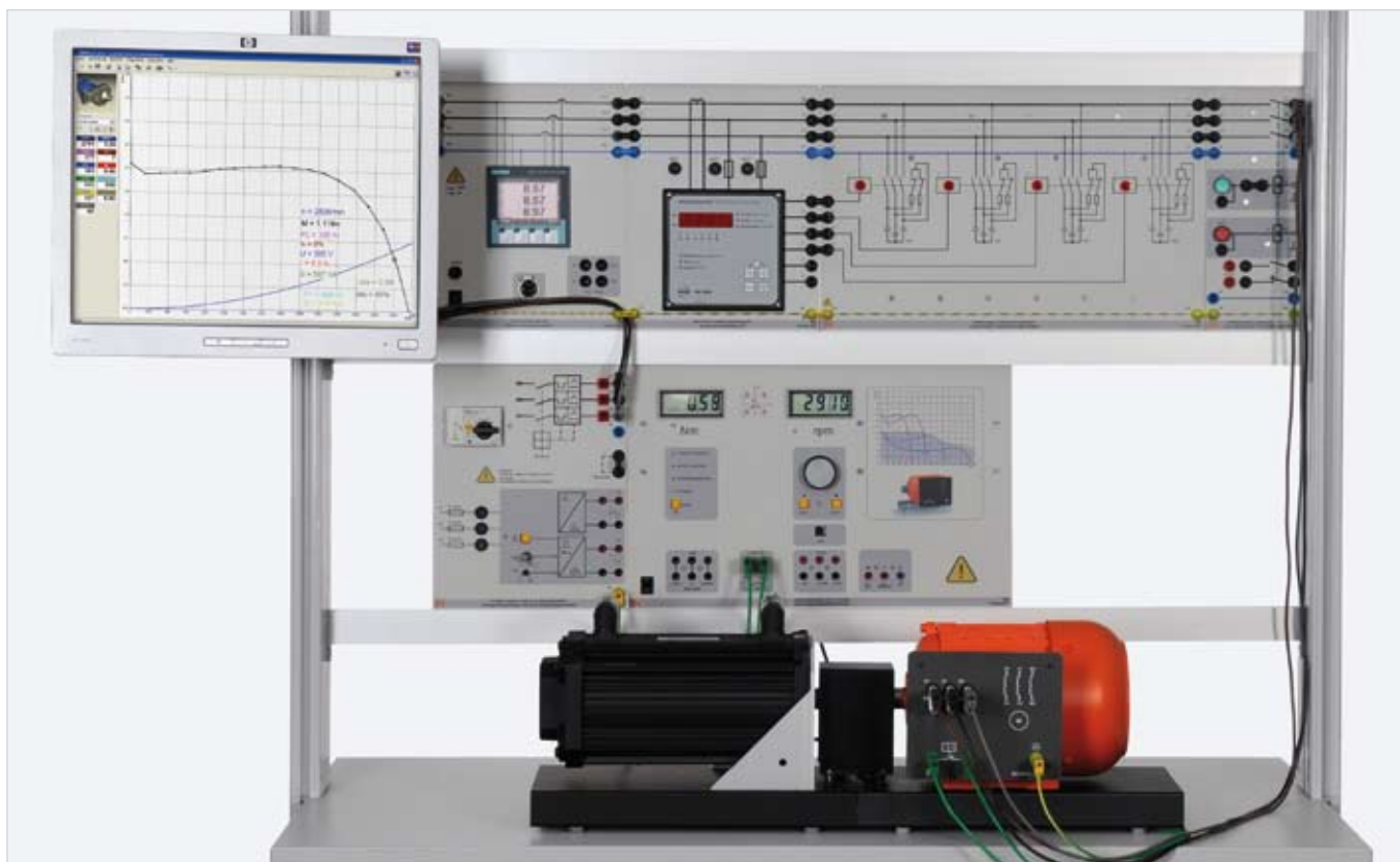
Príklad zapojenia „Automatická kompenzácia jalového výkonu EUC 3“
