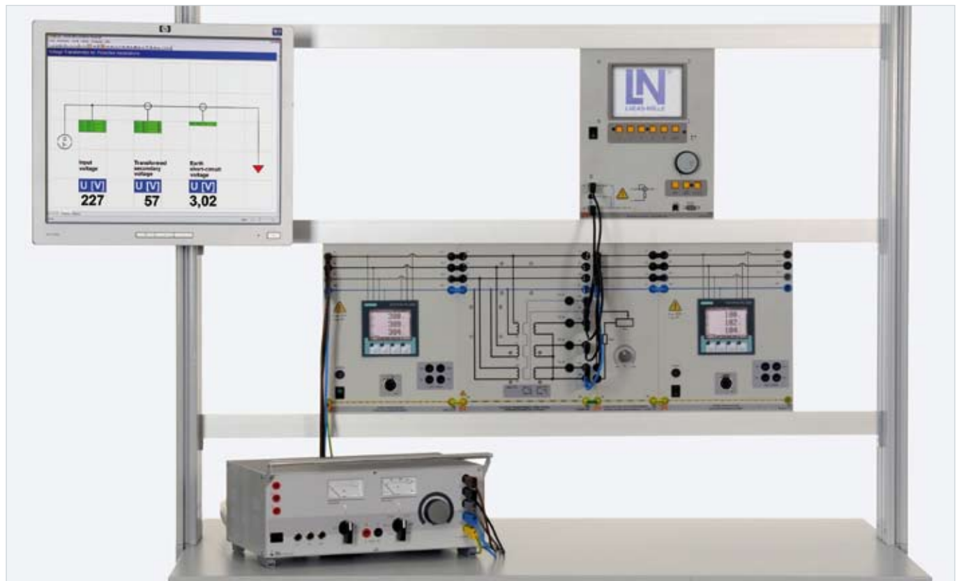
Príklad zapojenia „Transformátor EUB 2“
