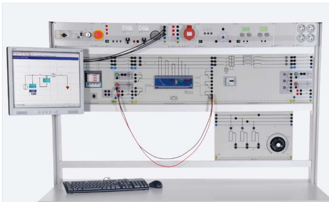
Príklad zapojenia „Nadprúdová ochrana ETP 2“
