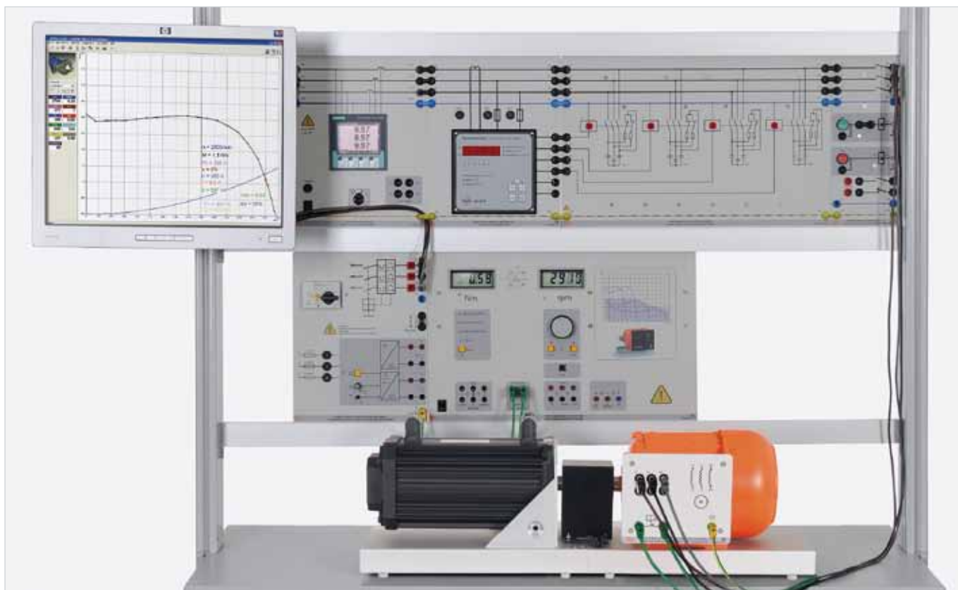
Versuchsbeispiel „automatische Blindleistungskompensation EUC 3“
