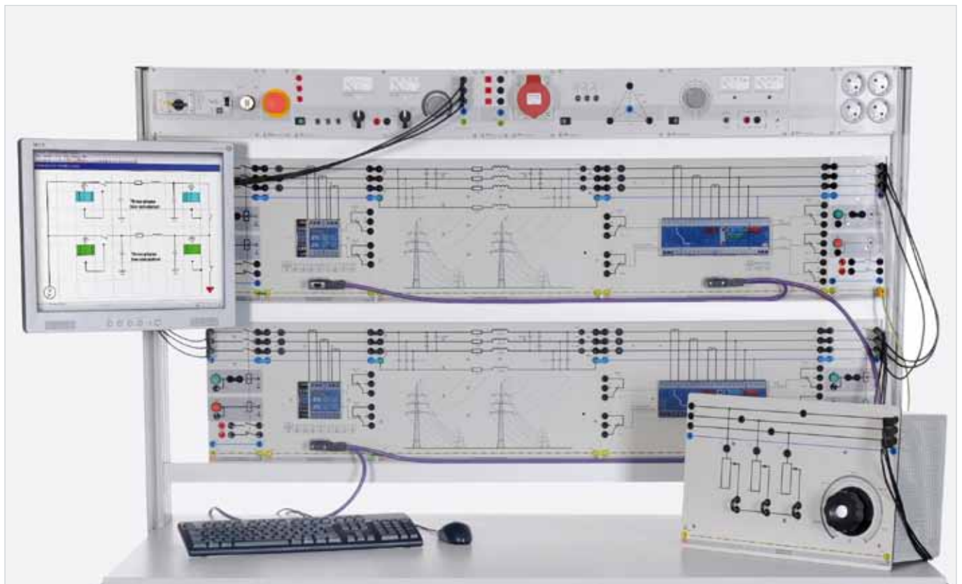
Versuchsbeispiel „Schutz paralleler Leitungen ELP 6“
