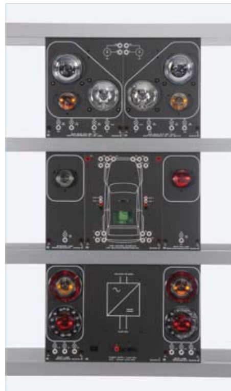
Лабораторная работа : «Управление системой освещения транспортного средства с помощью шины CAN» используя интерфейс SO3216-2Z и дополнительные компоненты
