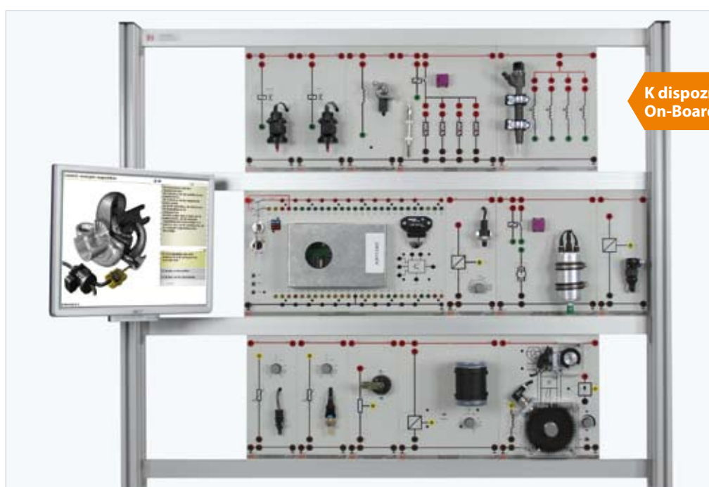
Príklad zapojenia „Common-Rail“
