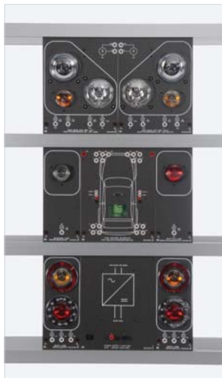
Zapojení „CAN-Bus-řízení osvětlení vozidla“ s interface SOI3216-2Z a přidavnými komponenty
