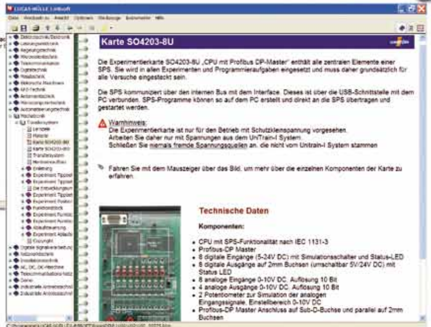
Experimentierkarte - enthält alle zentralen Elemente einer SPS
