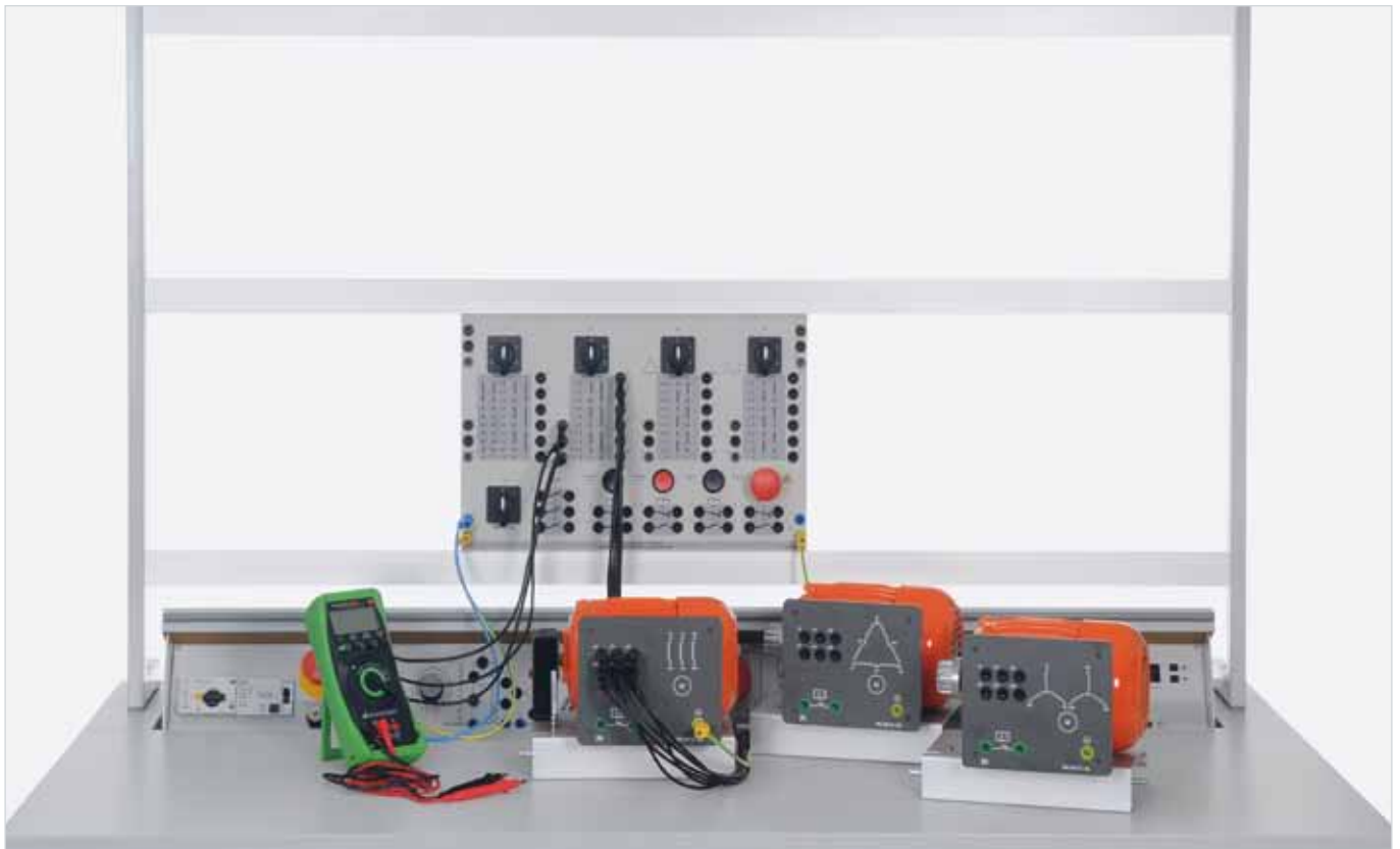
Versuchsbeispiel „Handbetätigtes Schalten im Drehstromkreis EST 1“
