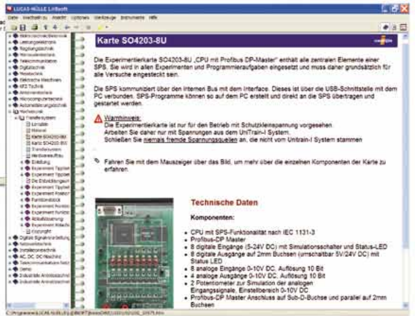
Experimentierkarte - enthält alle zentralen Elemente einer SPS
