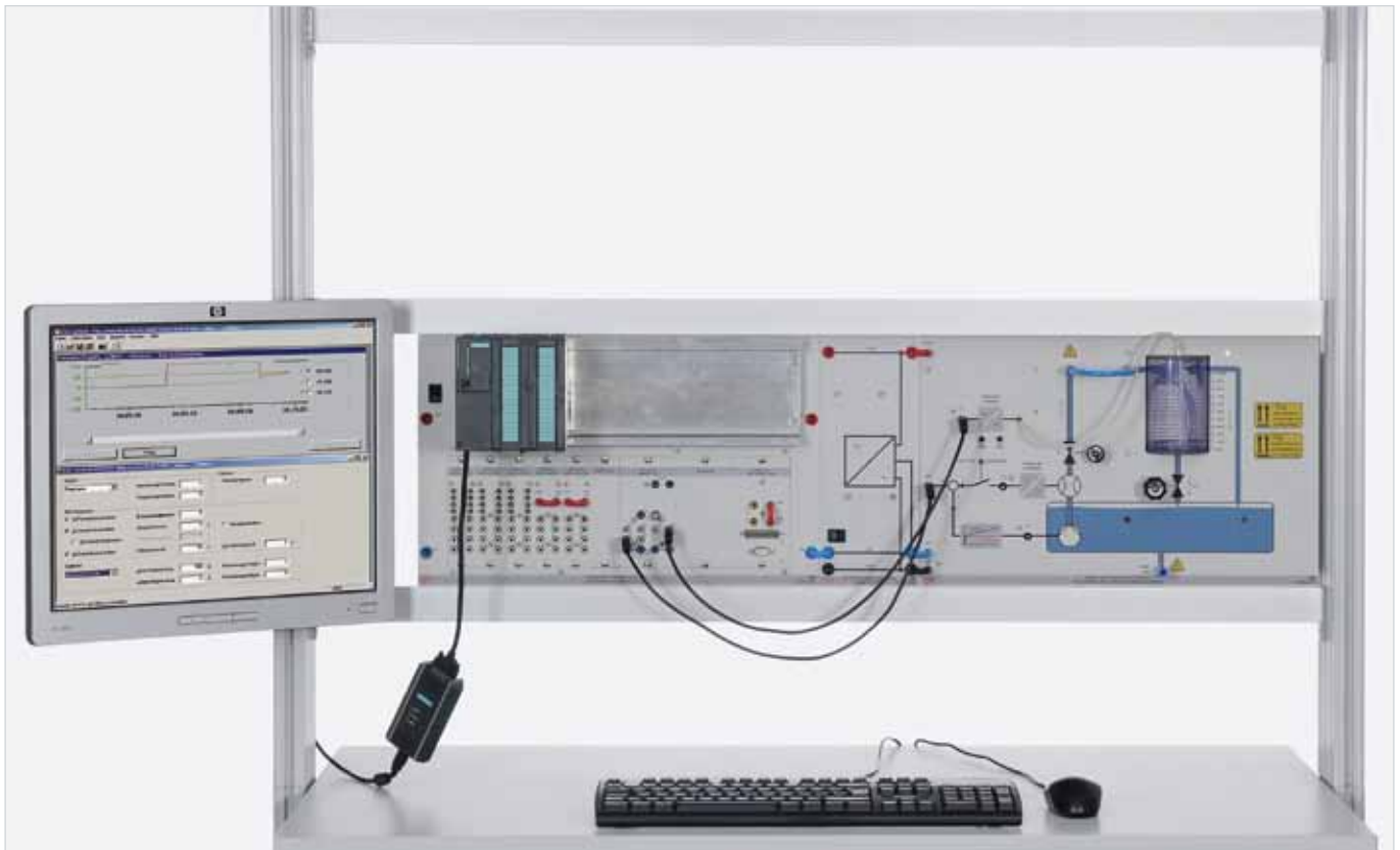
Versuchsbeispiel „Füllstandsregelstrecke CLC 36“
