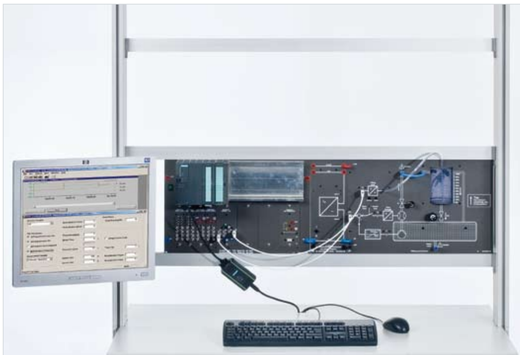
ตัวอย่างการทดลอง“การควบคุมระดับของของเหลวแบบวงจรมัดด้วยชุด CLC 36”
