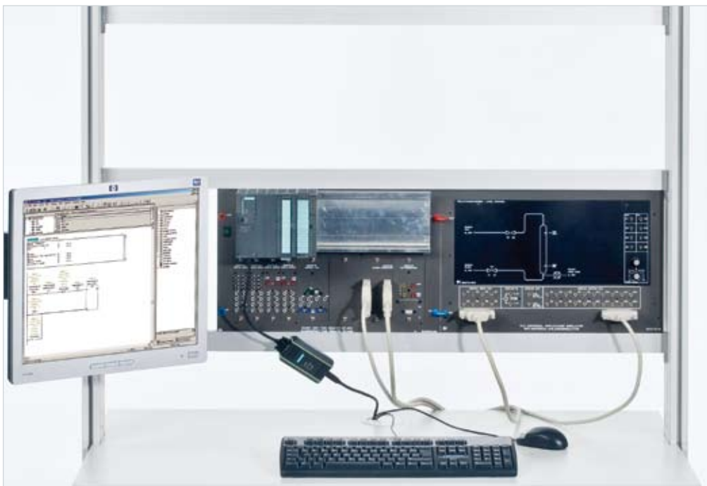
ตัวอย่างการทดลอง ,, PLC กระบวนการจำลองแบบยูนิเวอร์แซล โมเดล CLC 34"
