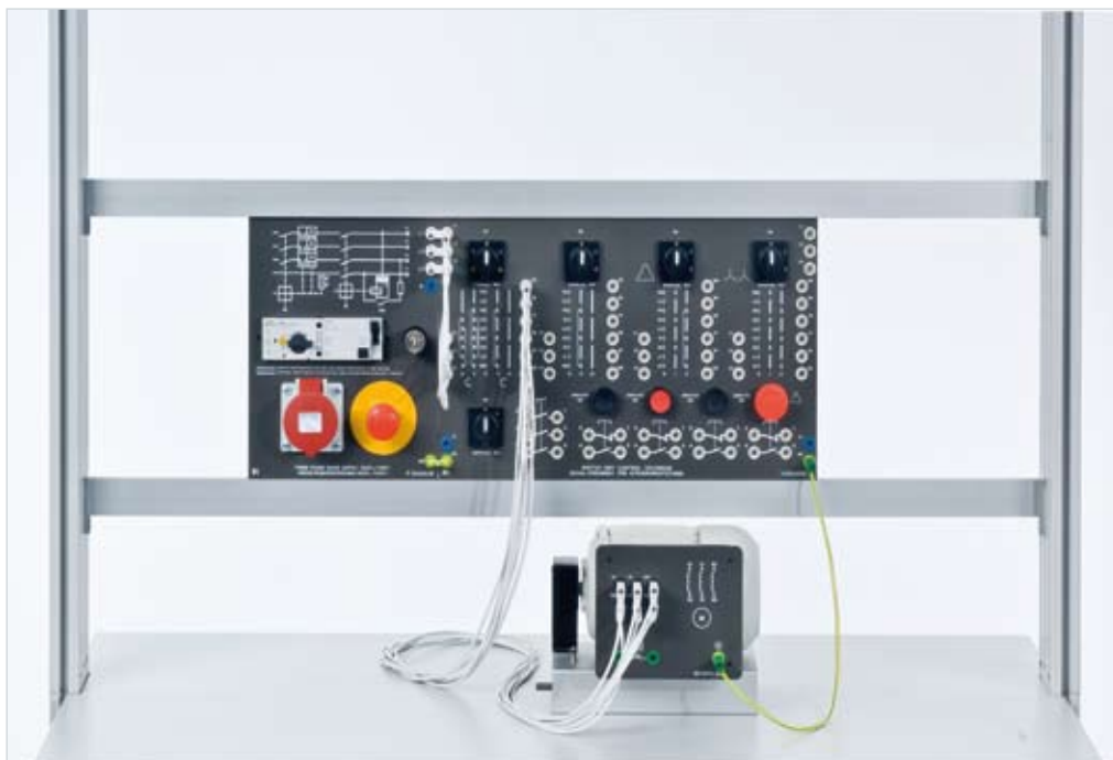
ตัวอย่างการทดลอง „การควบคุมสวิตช์ในวงจรสามเฟสแบบควบคุมด้วยมือ ด้วยชุดทดลอง EST 1“
