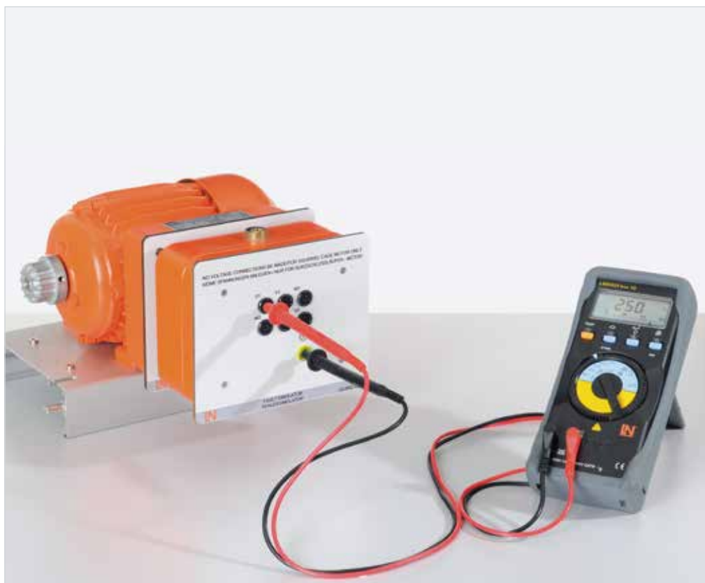
Versuchsbeispiel „Schutz elektrischer Maschinen EEM 4.5“
